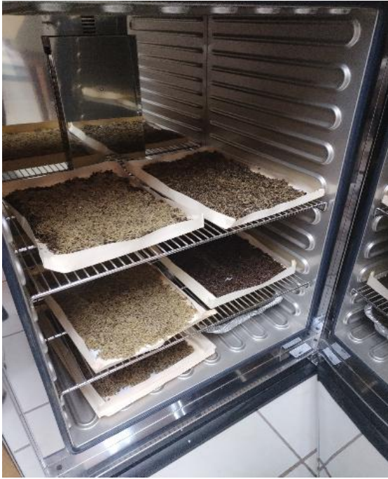
Figura 17. Deshidratación de larvas y pupas a 65°C durante 6 horas.
