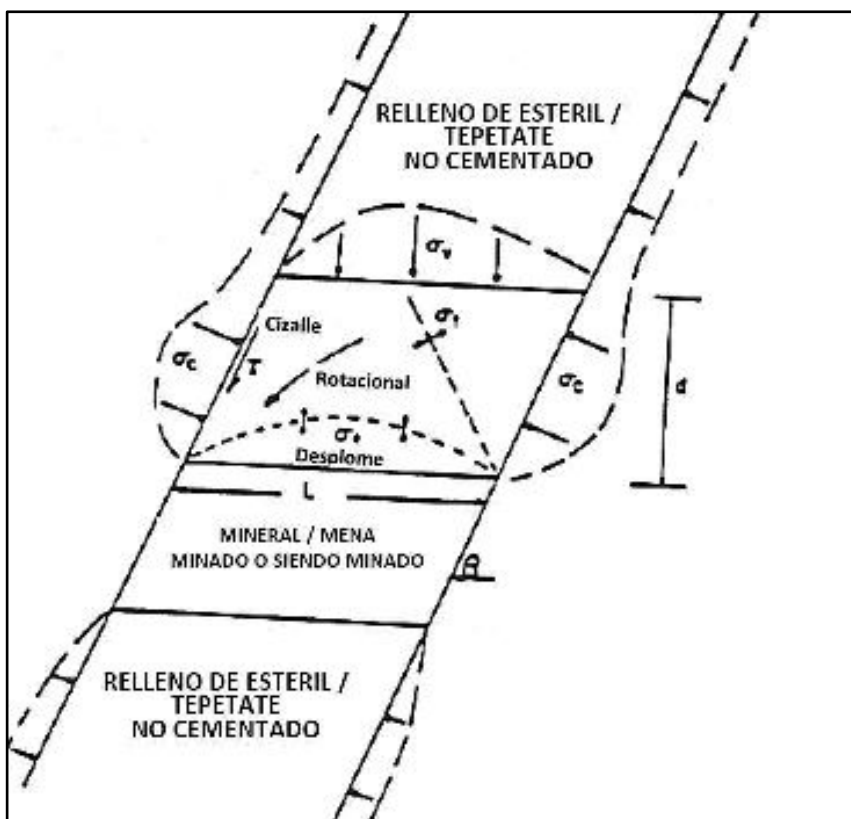
Figura Nro. 29: Diagrama de esfuerzos de la losa de relleno cementado
