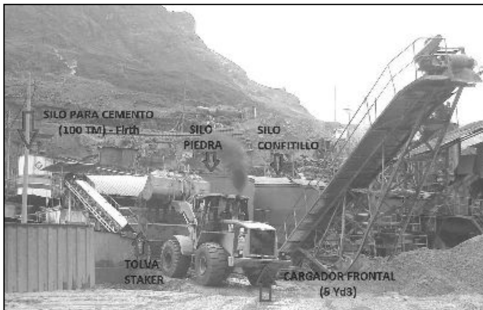
Figura Nro. 34: Planta de relleno cementado
