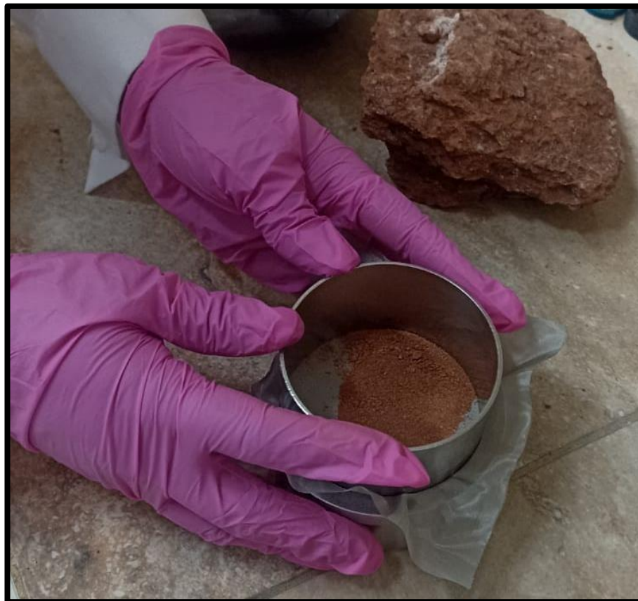
Figura 12— Tamizaje de muestra con una malla de 325, 44micrones.
