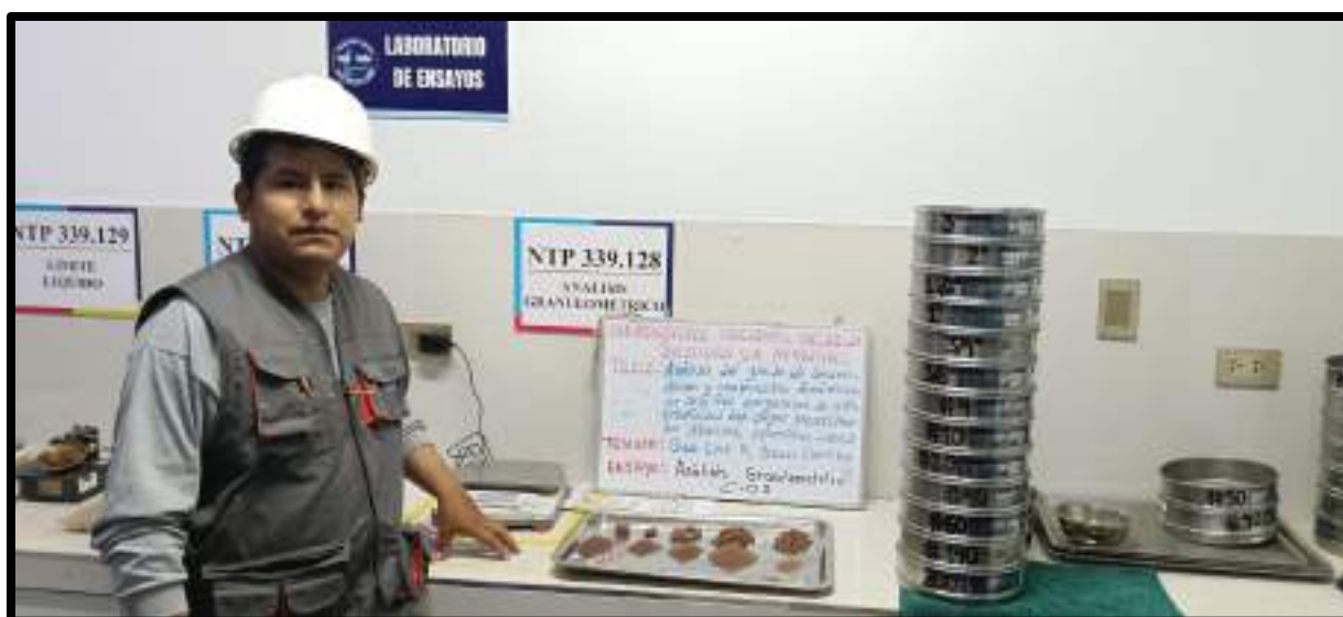
Figura 118 — Análisis granulométrico calicata C-05
