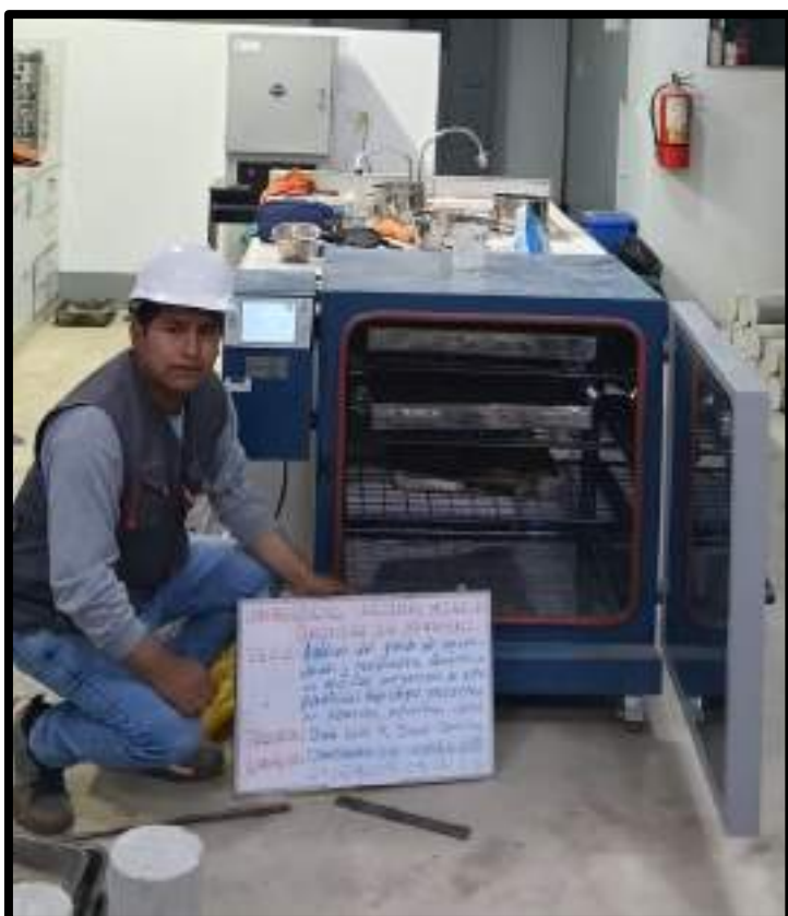
Figura 112 — Colocación de muestra en horno para cálculo de contenido de humedad de calicatas C-01, C-02, C-03, C-04, C-05 y C-06
