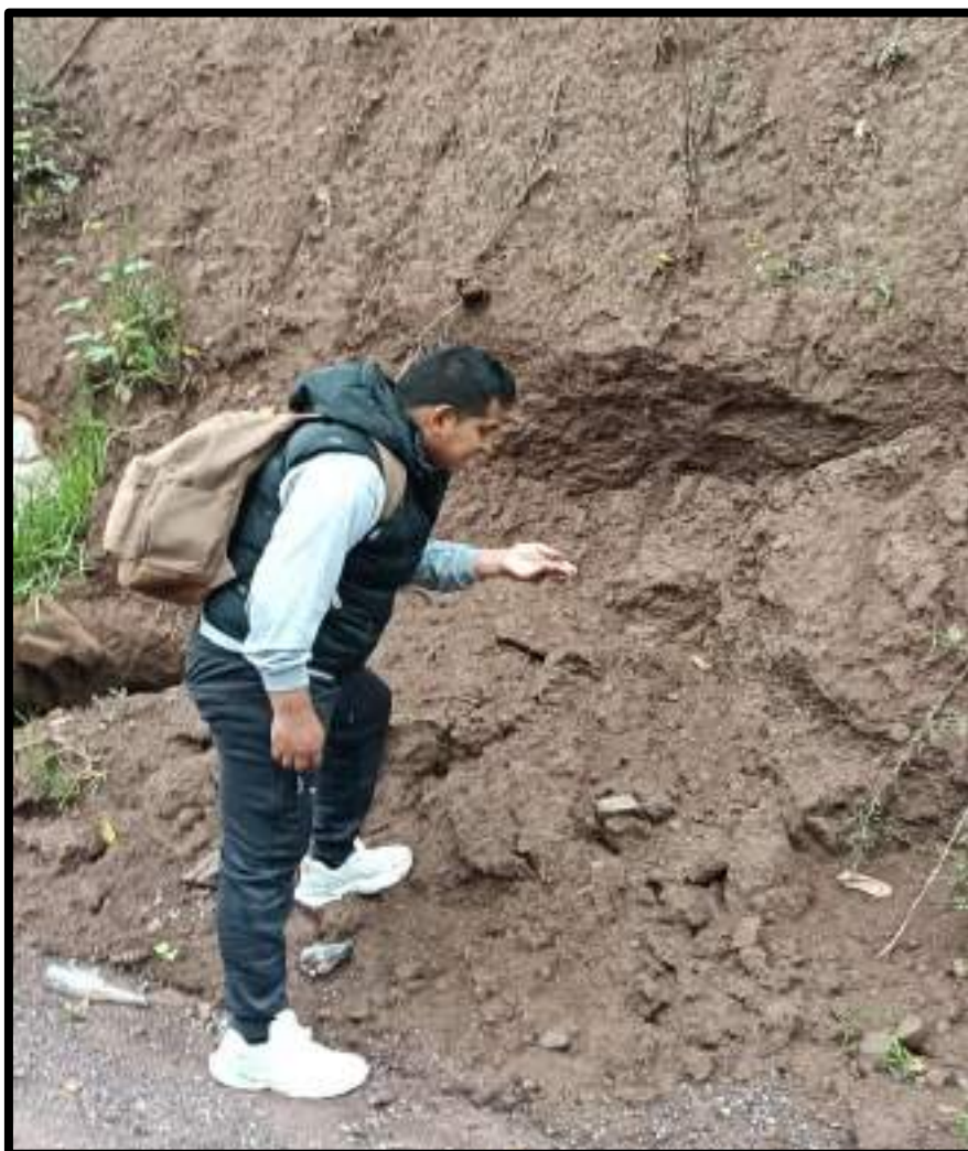
Figura 95 — Inspección visual de muestra para calicata C-01
