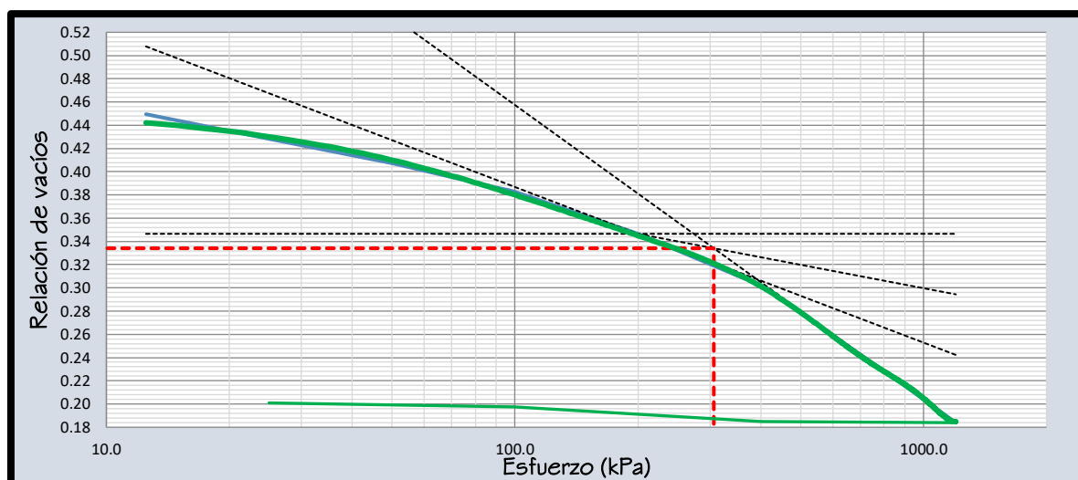
Figura 16 — Gráfico relación de vacíos vs esfuerzo de la C-04
