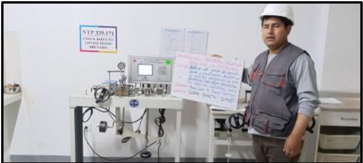
Figura 132 — Ensayo de corte directo para calicata C-06
