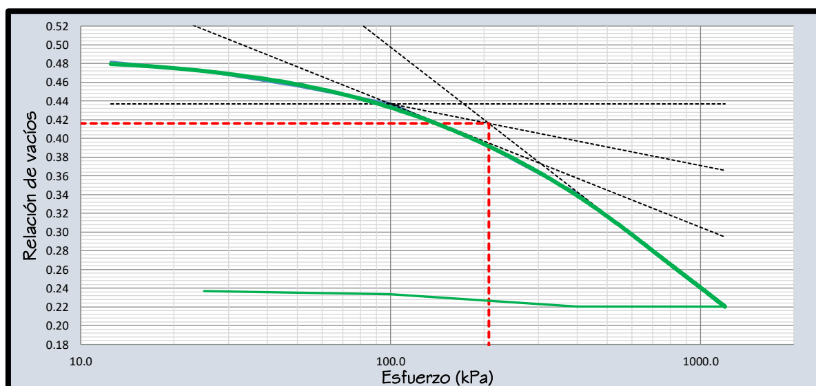
Figura 15 — Gráfico relación de vacíos vs esfuerzo de la C-03
