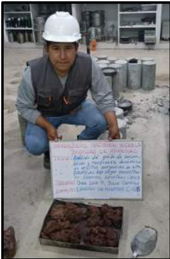
Figura 110 — Cuarteo de muestra para la calicata 05
