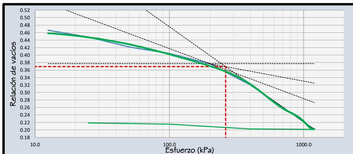
Figura 18 — Gráfico relación de vacíos vs esfuerzo de la C-06
