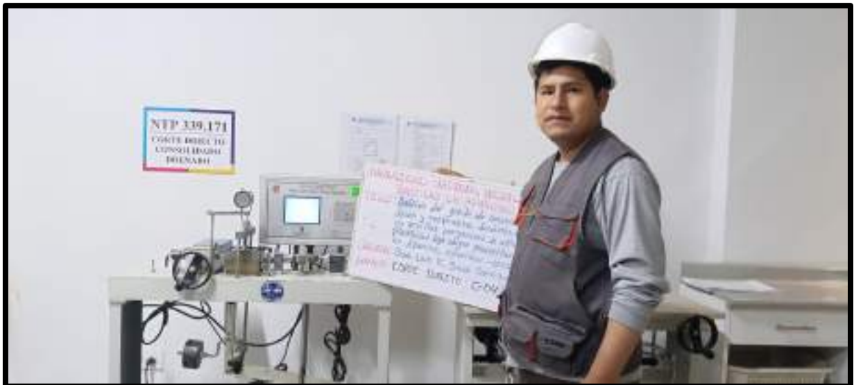
Figura 130 — Ensayo de corte directo para calicata C-04
