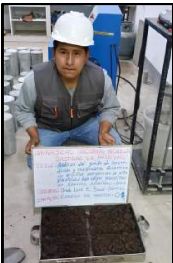
Figura 106 — Cuarteo de muestra para la calicata 01
