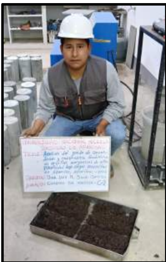
Figura 107 — Cuarteo de muestra para la calicata 02
