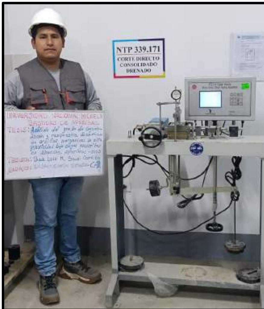
Figura 128 — Ensayo de corte directo para calicata C-02
