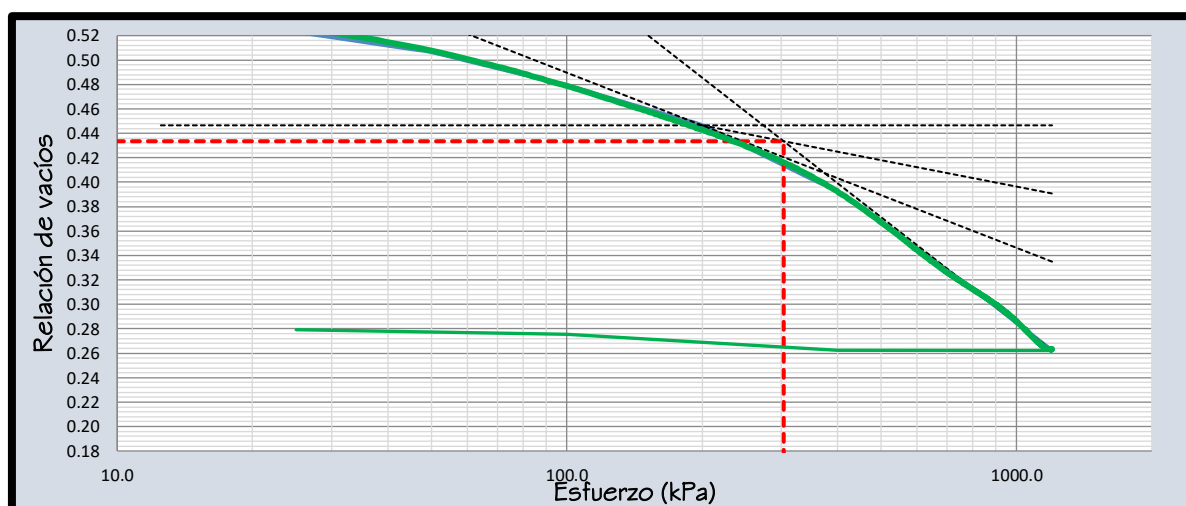
Figura 17 — Gráfico relación de vacíos vs esfuerzo de la C-05
