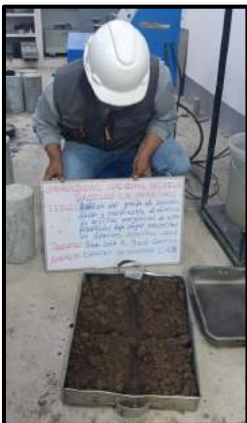
Figura 108 — Cuarteo de muestra para la calicata 03
