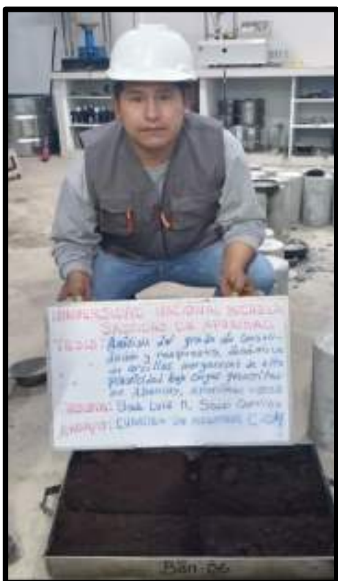
Figura 109 — Cuarteo de muestra para la calicata 04
