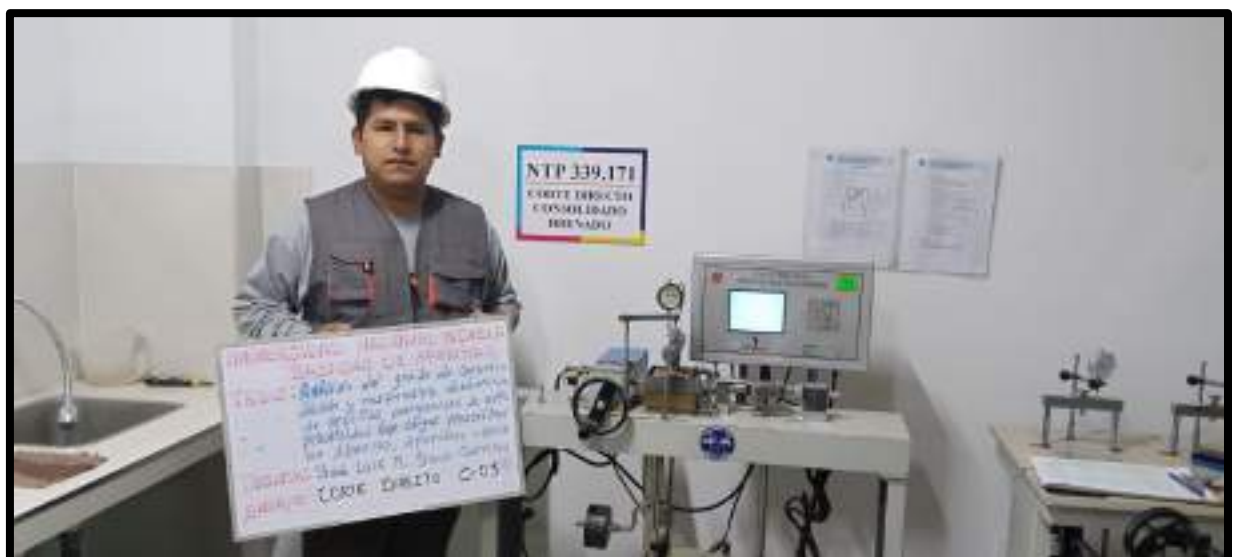
Figura 129 — Ensayo de corte directo para calicata C-03
