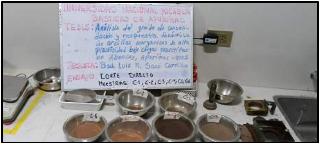
Figura 126 — Muestras para ensayo de corte directo de calitas C-01, C-02, C-03, C-04, C-05 y C-06
