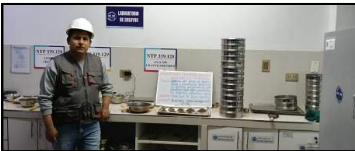
Figura 114 — Análisis granulométrico C-01
