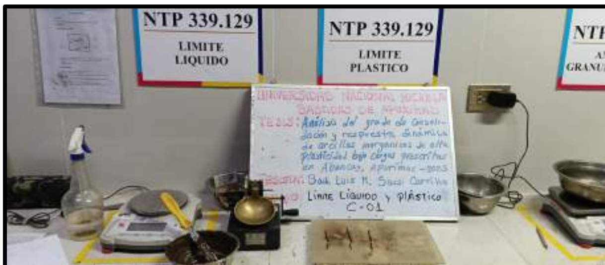
Figura 120 — Limites de Atterberg para la calicata C-01
