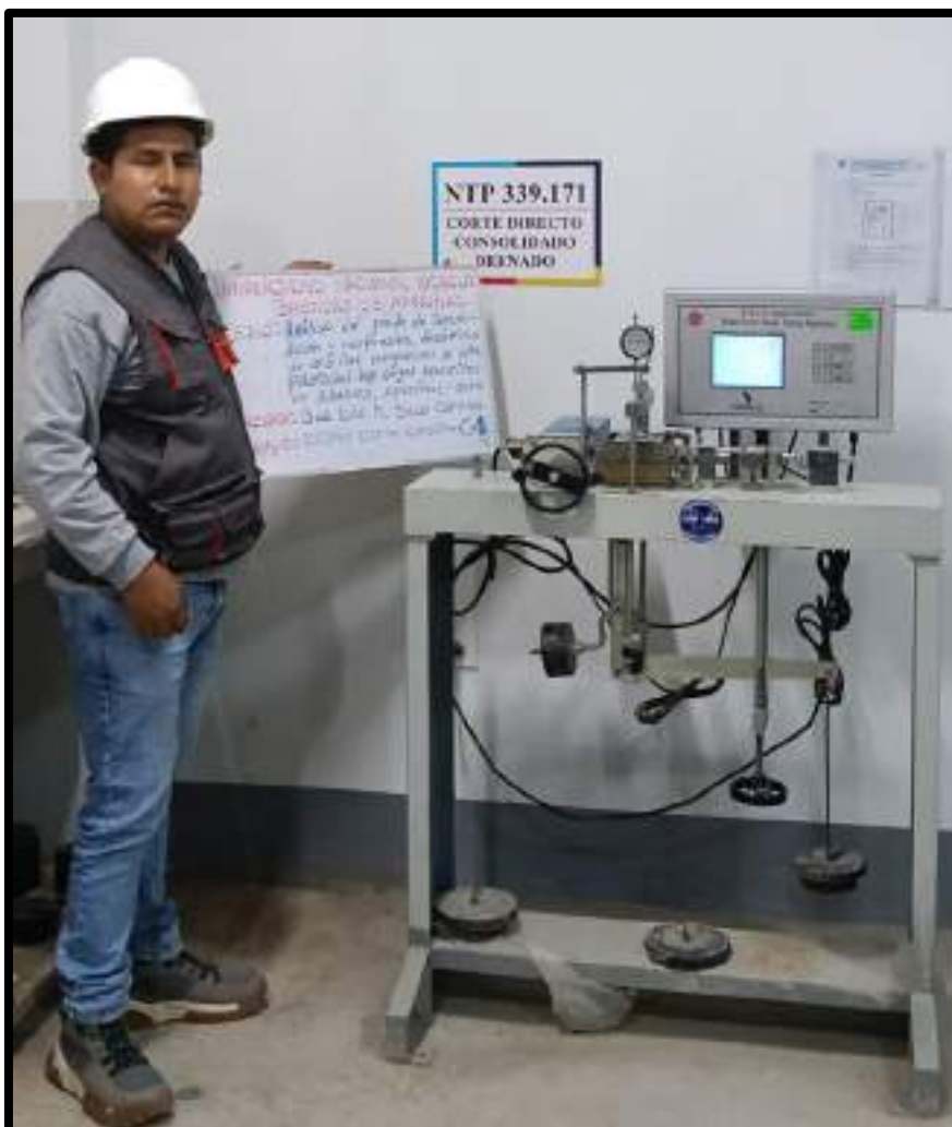
Figura 127 — Ensayo de corte directo para calicata C-01
