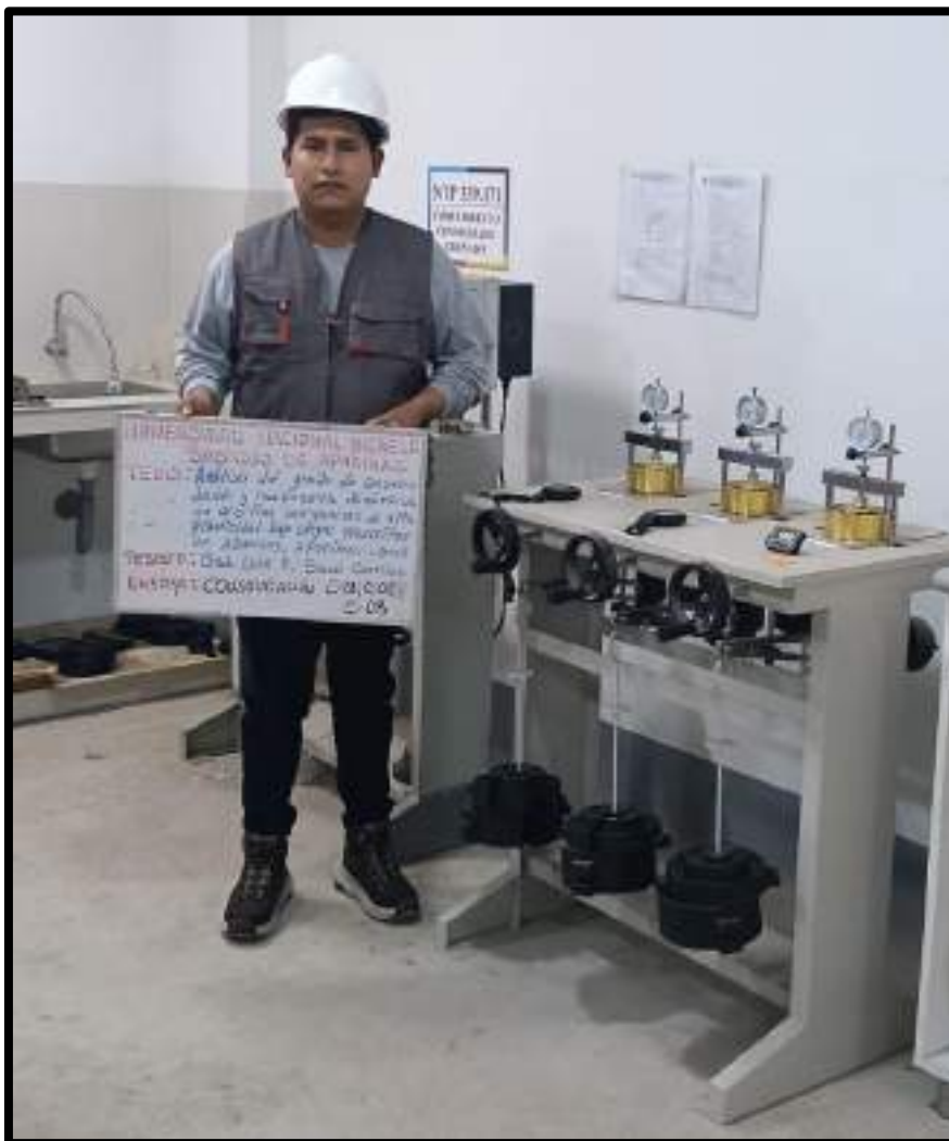
Figura 133 — Ensayo de consolidación para determinar el grado de consolidación
