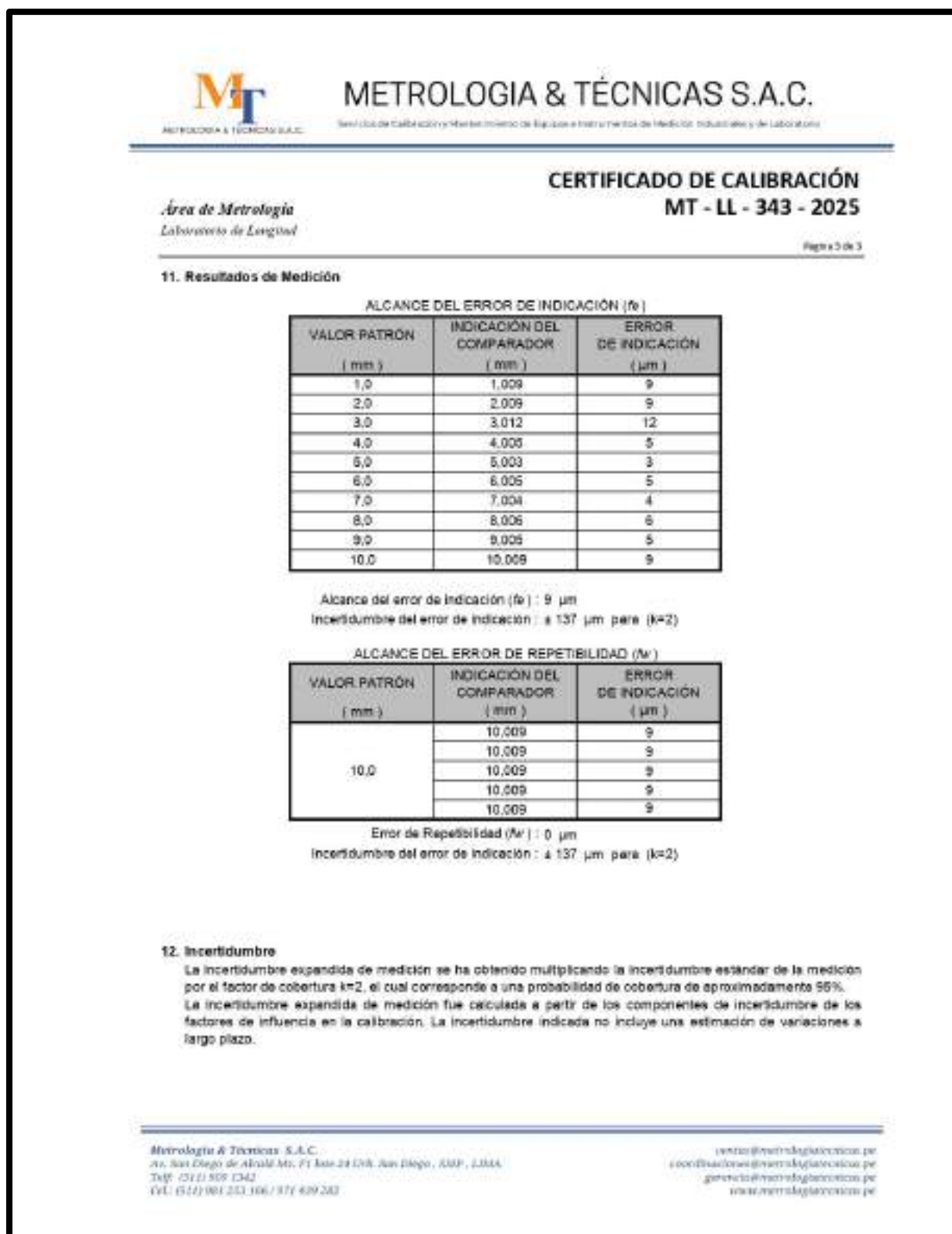
Figura 209 — Certificado de calibración - Dial MT-LL-343-2025 parte 03
