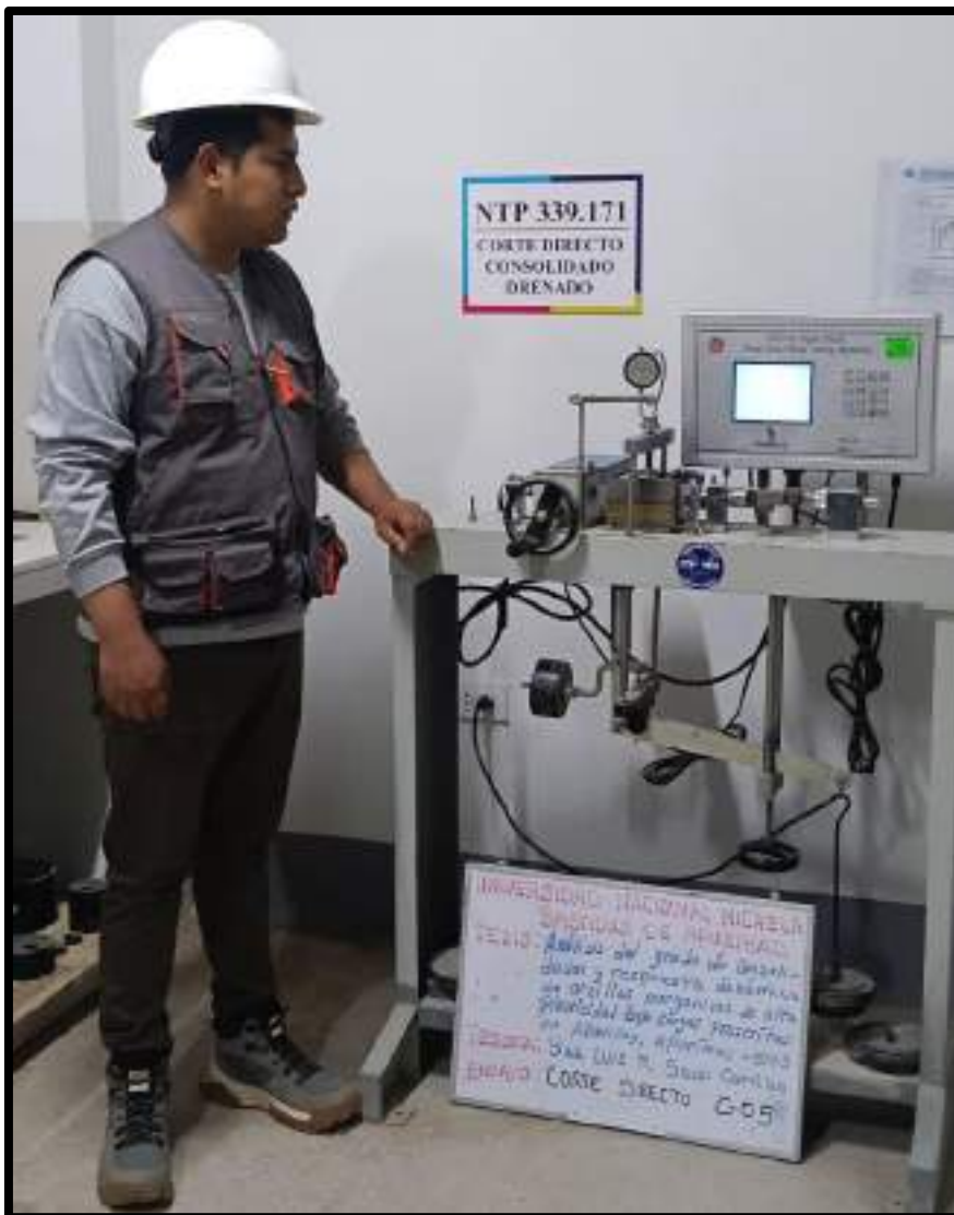
Figura 131 — Ensayo de corte directo para calicata C-05
