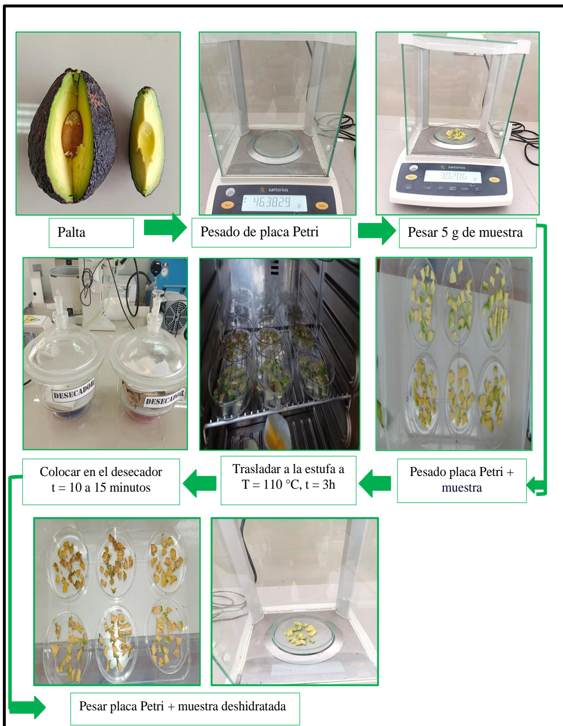
Figura 39 — Procedimiento para la determinación de humedad de dos variedades de palta (Hass y Fuerte), según AOAC 984.25 (2005)
