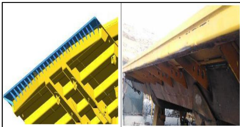
Figura 20 — Vista inferior prototipo de cola de pato en tolva de camión Komatsu 930E-4SE
