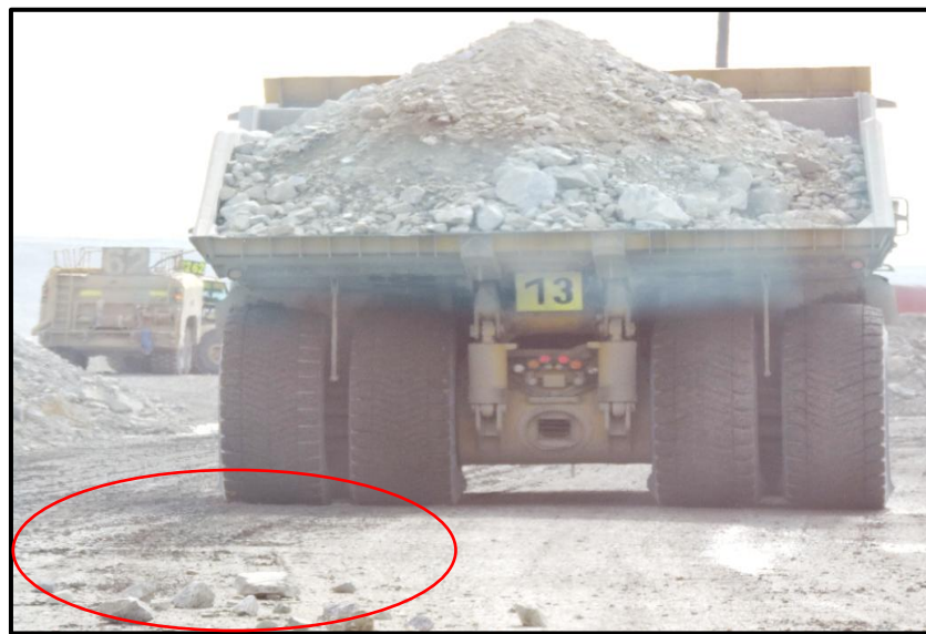
Figura 8 — Derrame de material en flota de camiones Komatsu 930E-4SE
