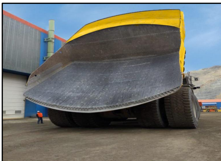
Figura 5 — Revestimiento de tolvas
