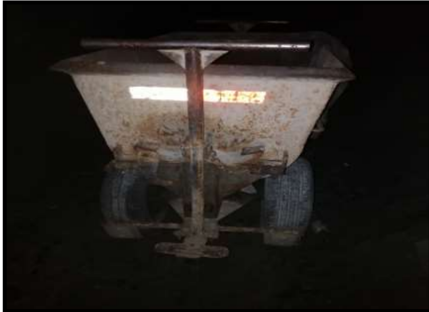
Foto IV-14: Se adquirió un carrito minero de capacidad de 100kg que remplazara al buggy para realizar el carguío de material.
