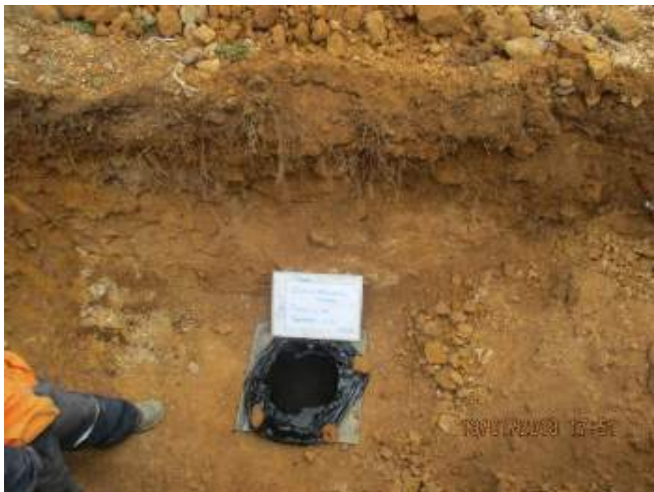
Fotografía N°7: Ensayo de densidad de campo por el método de reemplazo de agua.
