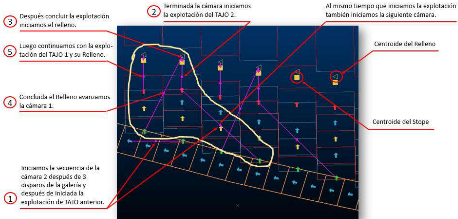
Figura N° 24: Secuencia de salida manual y no automática; Aquí la secuencia se realizara trazando líneas de acuerdo al ciclo de minado.
