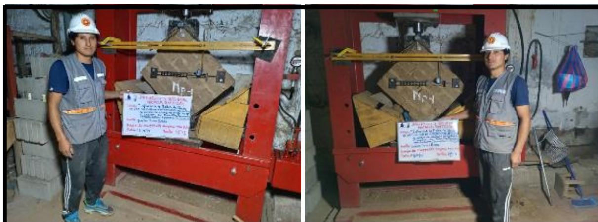
Figura 71 — Ensayo de compresión diagonal de muretes con refuerzo de mallas de 8 cm
