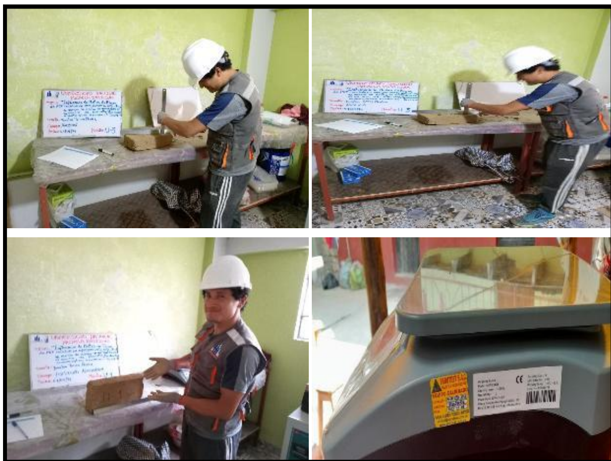
Figura 65 — Muestra el ensayo de alabeo
