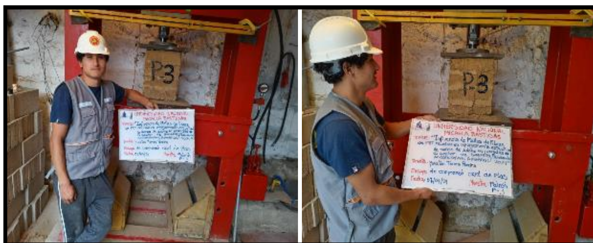
Figura 69 — Ensayo de compresión axial de pilas con refuerzo de 8cm de abertura
