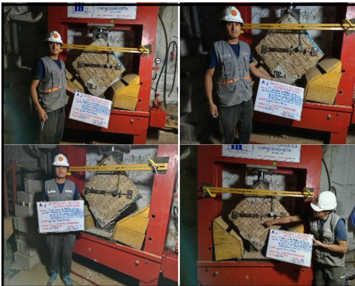
Figura 72 — Ensayo de compresión diagonal de muretes con refuerzo de mallas de 5 cm
