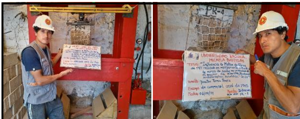
Figura 70 — Ensayo de compresión diagonal de muretes patrón sin refuerzo
