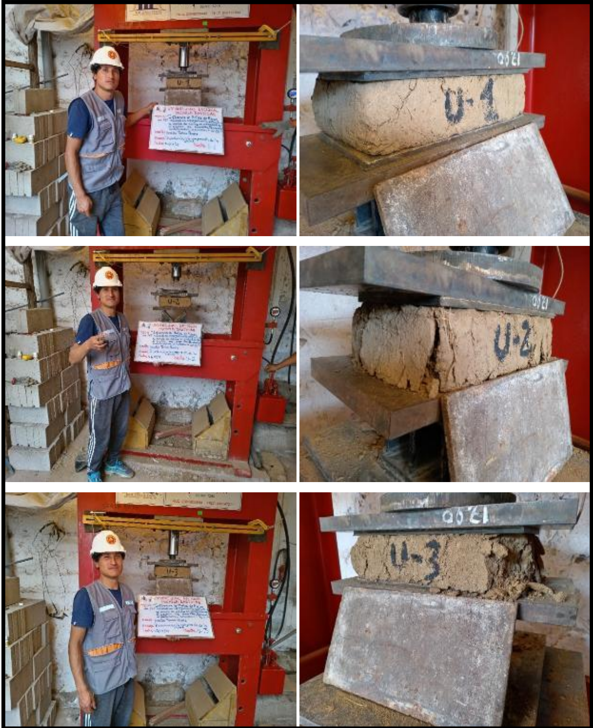
Figura 67 — Ensayo de resistencia a compresión de las unidades
