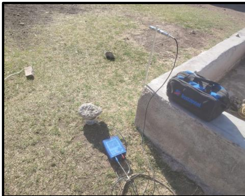
Figura 10 — Monitoreo de vibraciones con sismógrafo micromate
