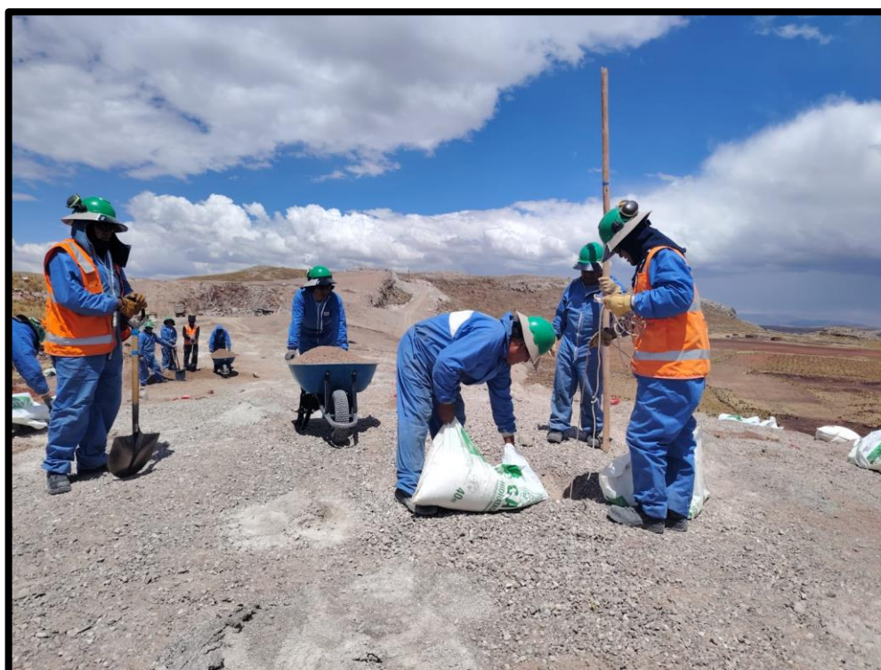
Figura 12 — Carguío de taladros con ANFO a granel
