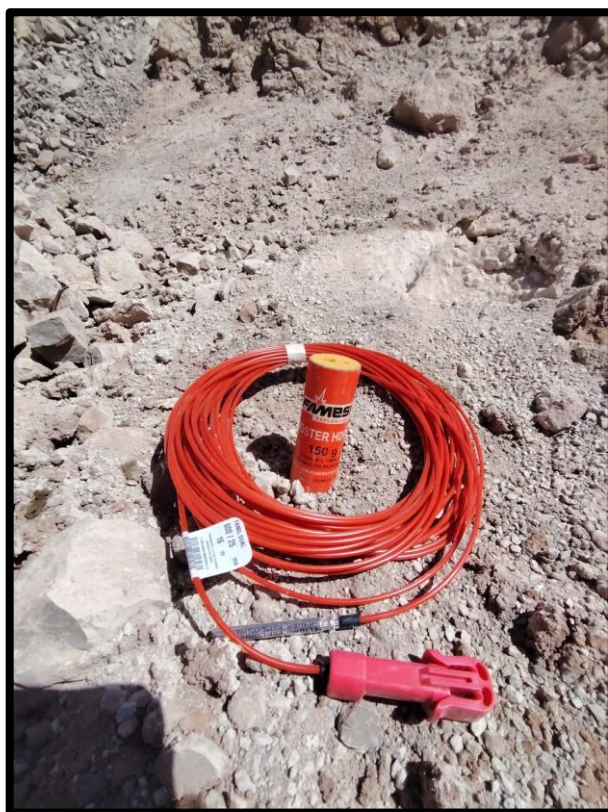
Figura 15 — Fanel dual y multiplicador Booster para el primado
