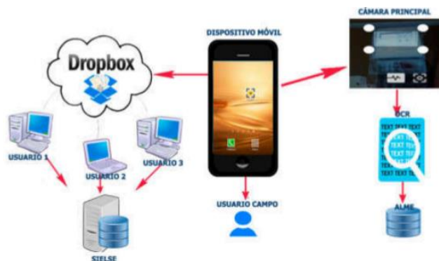
Figura 1. Arquitectura Lógica de la aplicación
