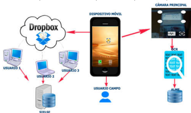
Figura 1. Arquitectura Lógica de la aplicación
