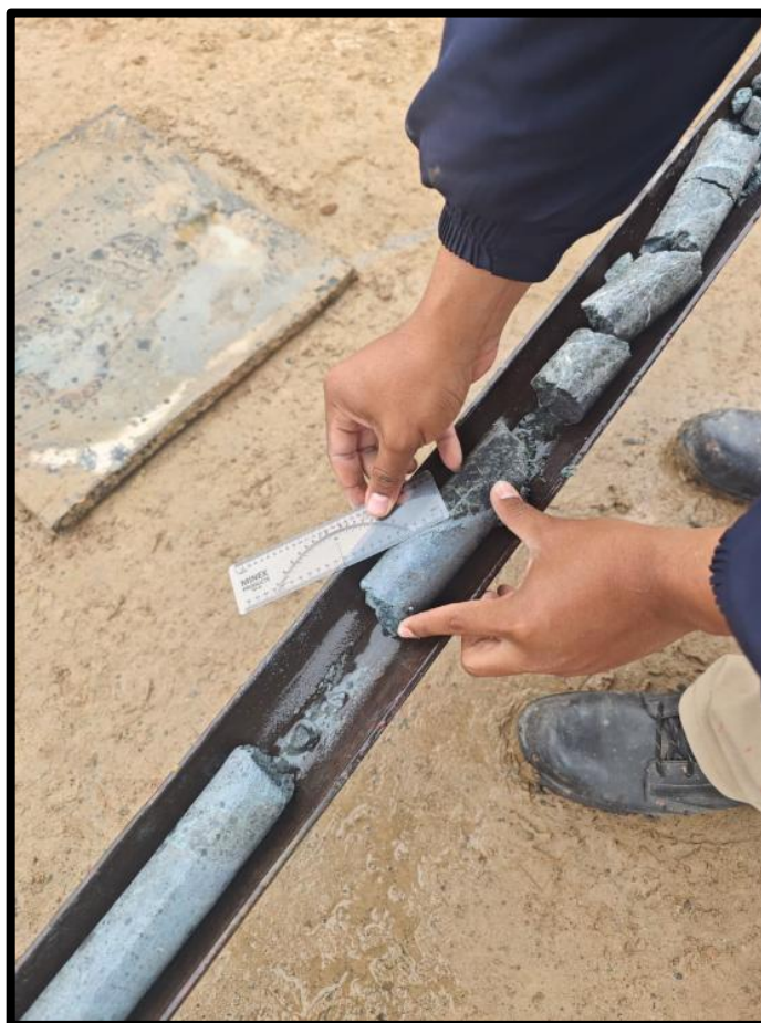
Figura 47 — Medición del dip de las discontinuidades
