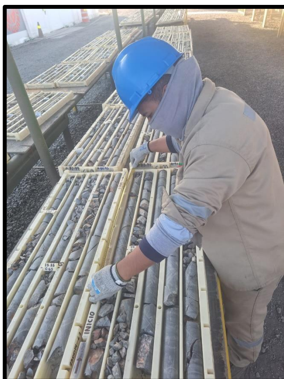
Figura 52 — Medición de RQD en los testigos de perforación
