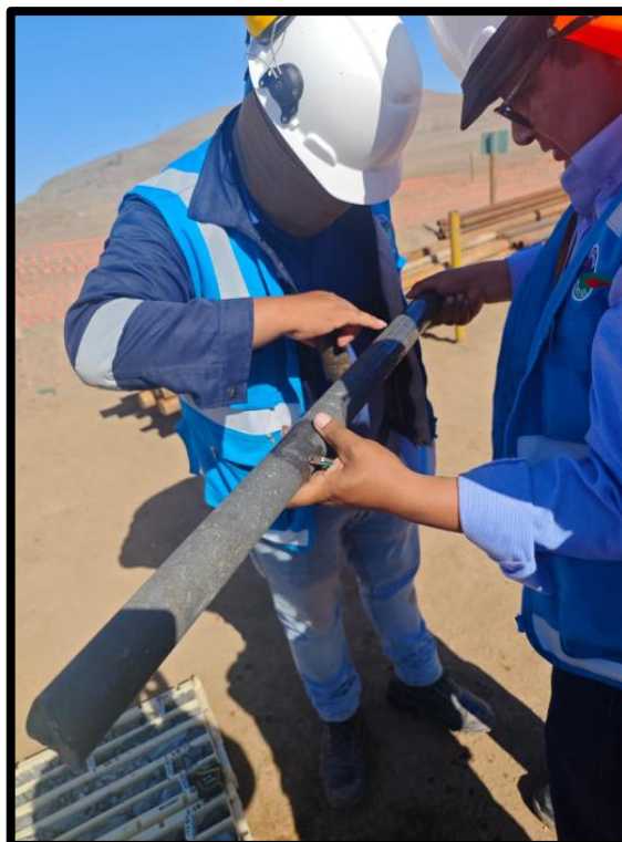
Figura 50 — Reconocimiento de testigos de perforación para obtener los parámetros geomecánicos.
