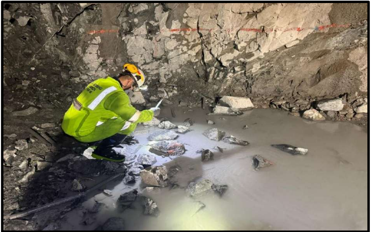
Figura 26 — Recolección de muestras litológicas en frente de avance
