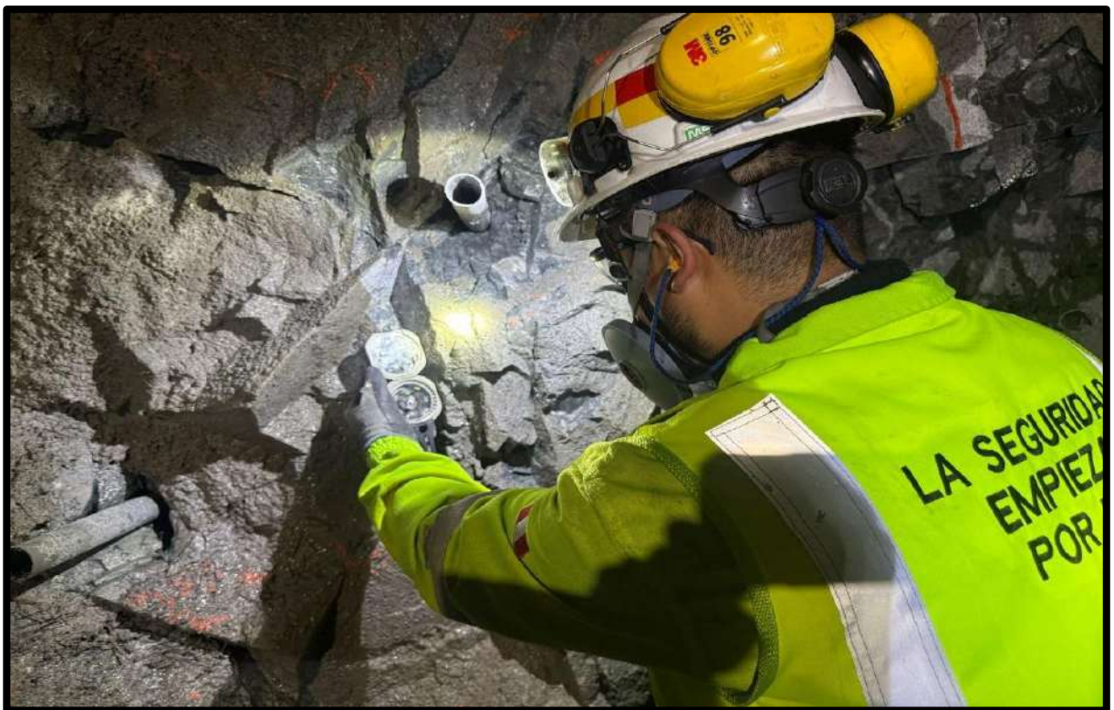
Figura 23 — Muestreo de campo del macizo rocoso
