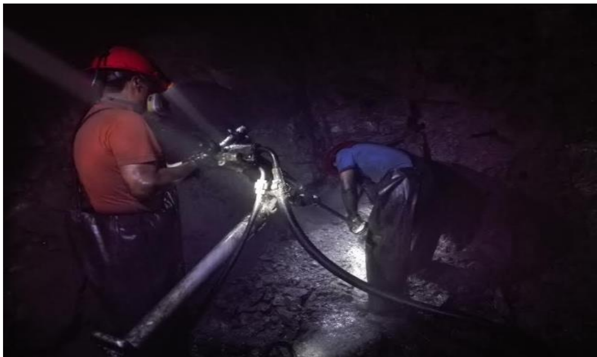
Foto 5: Perforación en el tajo 680. Maestro perforista y su ayudante.
