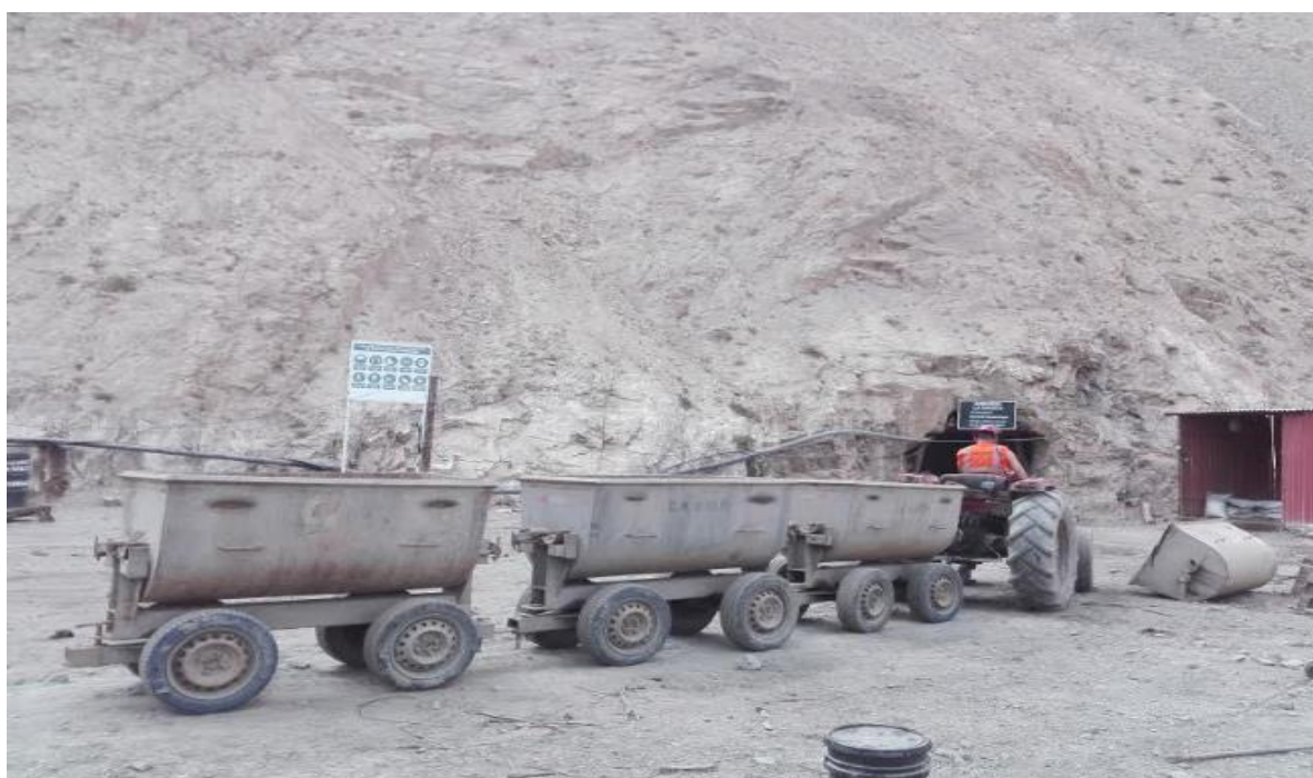
Foto 2: Coches mineros de 1.5 Tn que se utilizan para extraer el mineral de interior mina.
