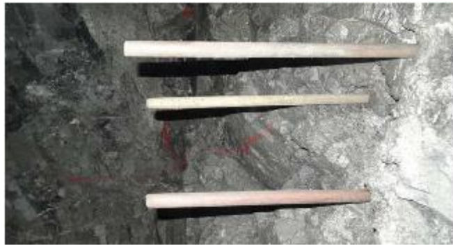
Figura 15. Paralelismo y equidistancia del arranque
