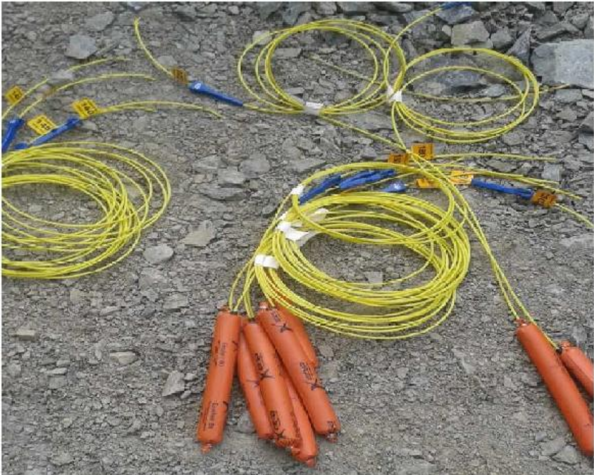
Figura 58. Correcta realización del cebo
