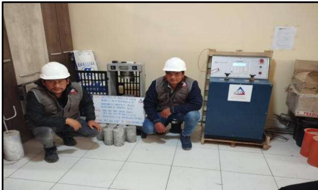
Figura 97 — Especímenes cilíndricos de concreto para ensayo de compresión en 28 días de MF 3.6 con AG: 1/2" V=0.51
