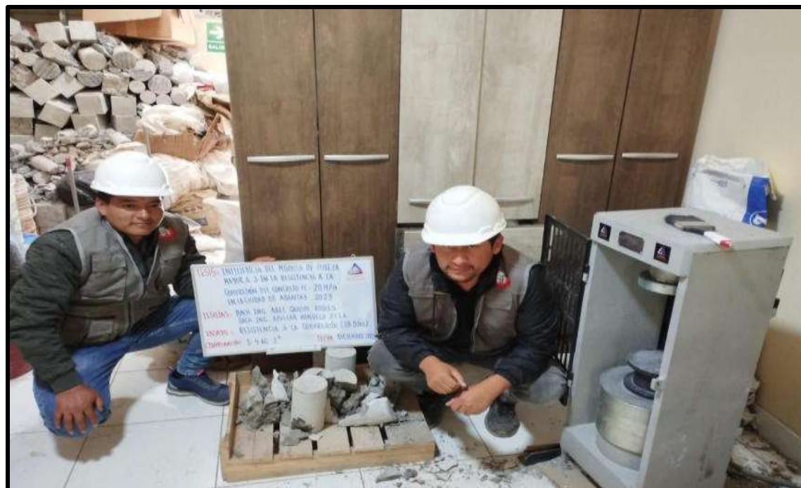
Figura 104 — Resistencia a la compresión en 28 días de MF 3.4 con AG: 1" V=0.64
