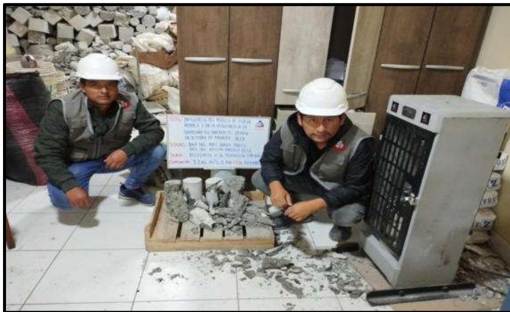
Figura 101 — Resistencia a la compresión en 28 días de MF 3.2 con AG: 3/4" V=0.58
