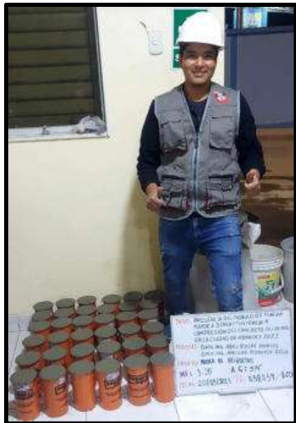
Figura 90 — Ensayo de elaboración de briquetas MF 3.2 agregado grueso 3/4"
