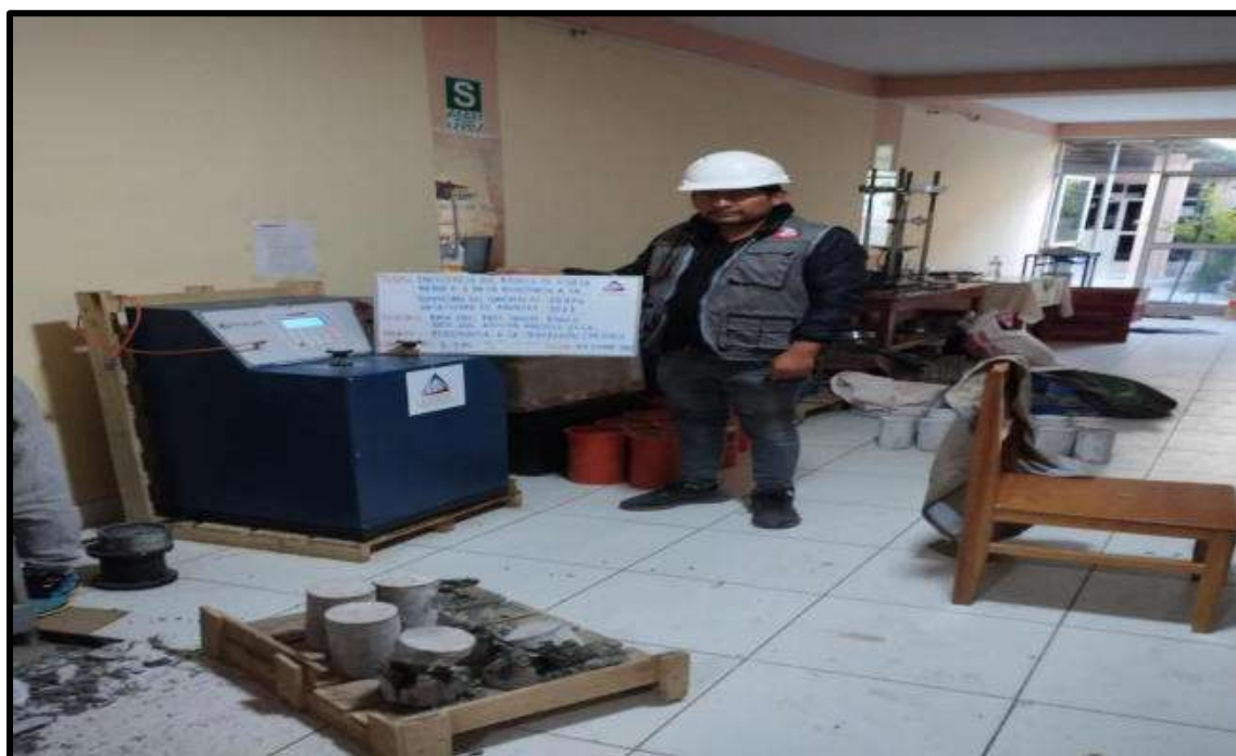
Figura 103 — Resistencia a la compresión en 28 días de MF 3.4 con AG: 1/2" V=0.51
