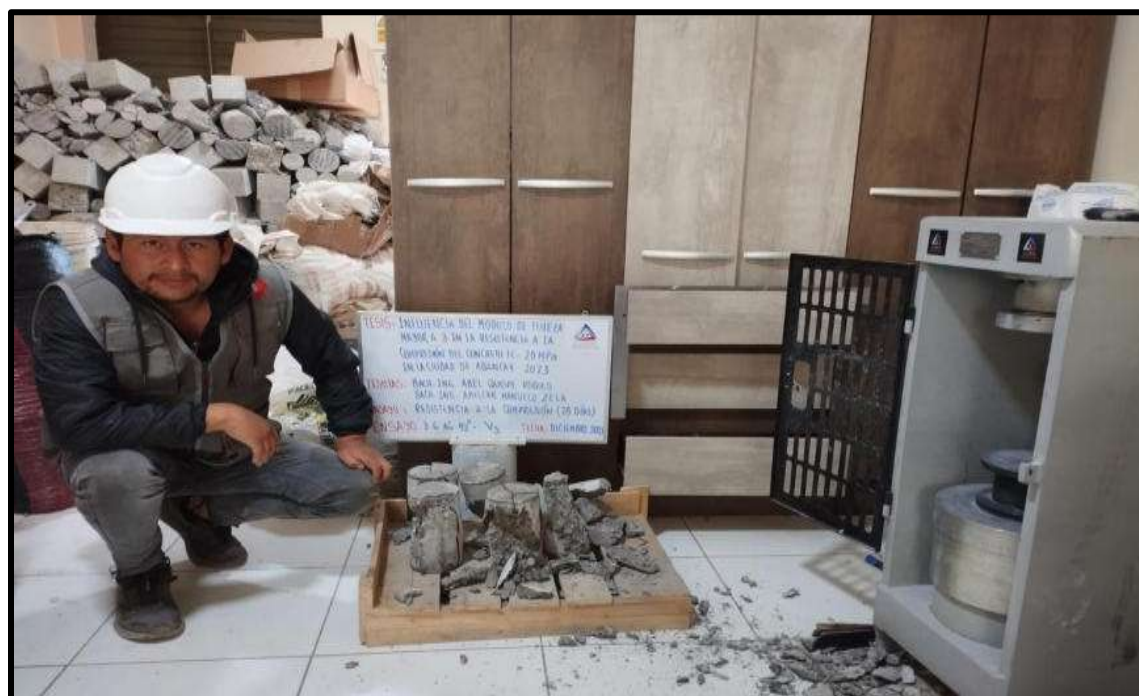
Figura 105 — Resistencia a la compresión en 28 días de MF 3.6 con AG: 1/2" V=0.51
