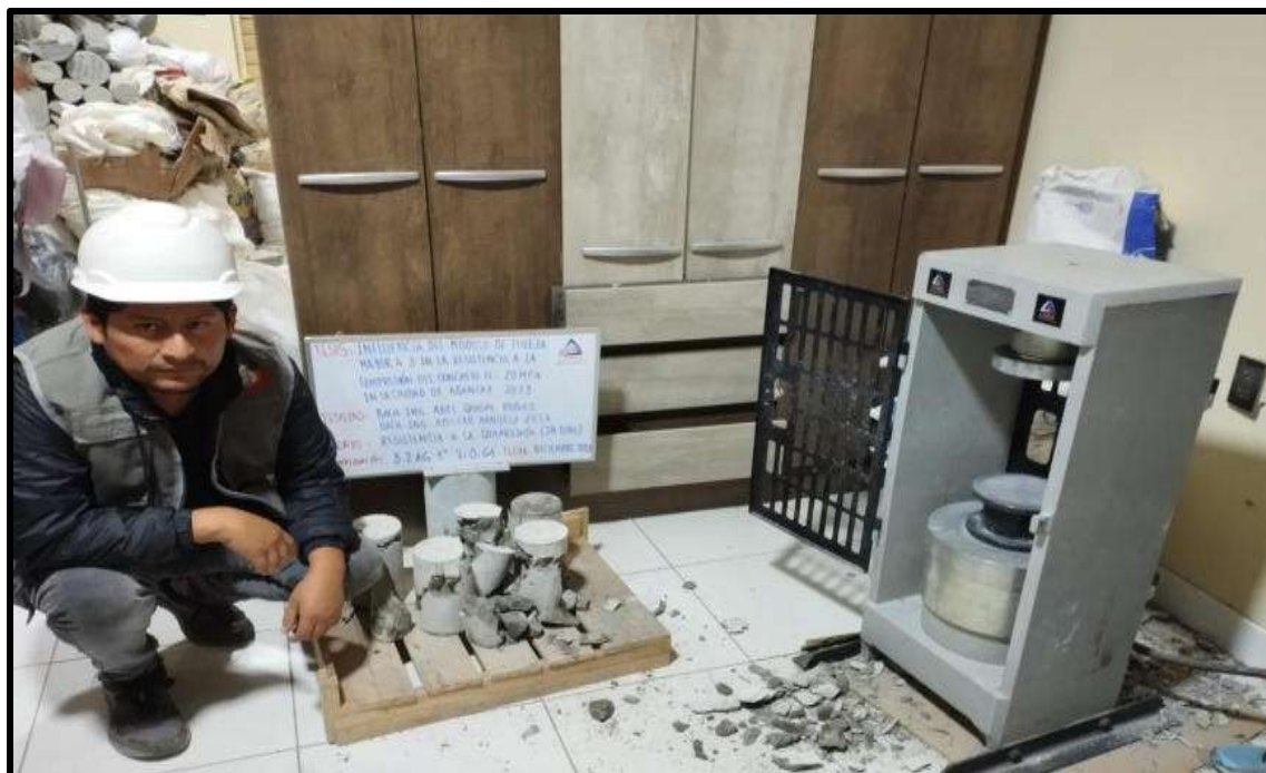
Figura 102 — Resistencia a la compresión en 28 días de MF 3.2 con AG: 1" V=0.64
