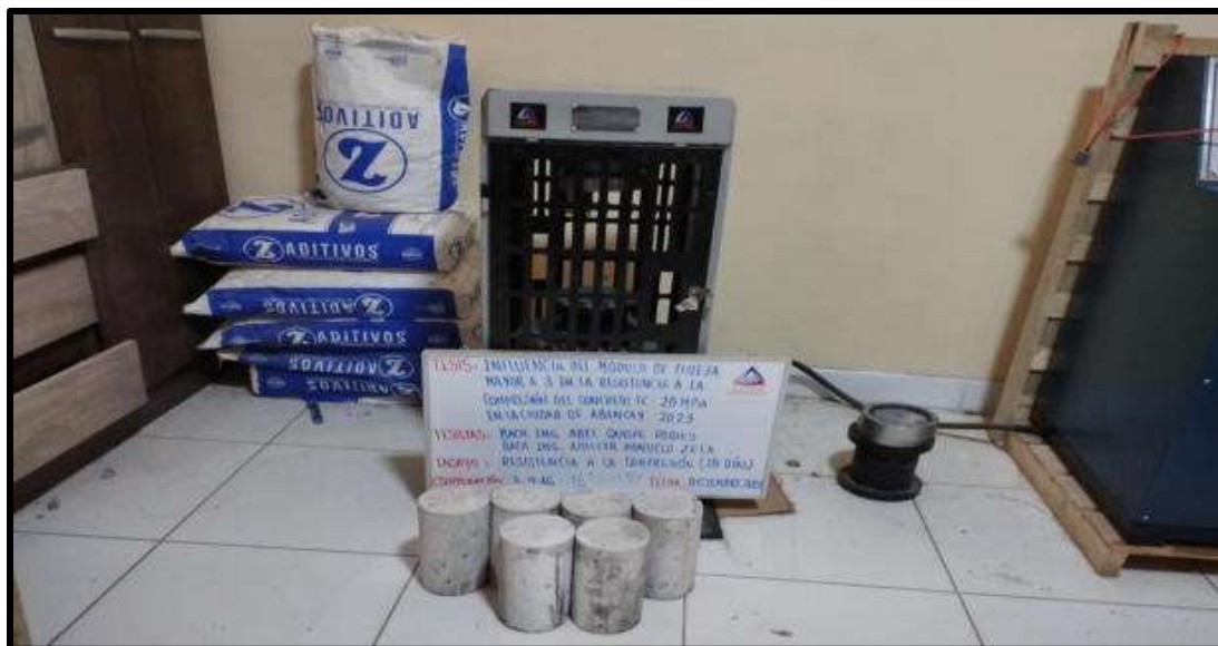
Figura 94 — Especímenes cilíndricos de concreto para ensayo de compresión en 28 días de MF 3.4 con AG: 1/2" V=0.51
