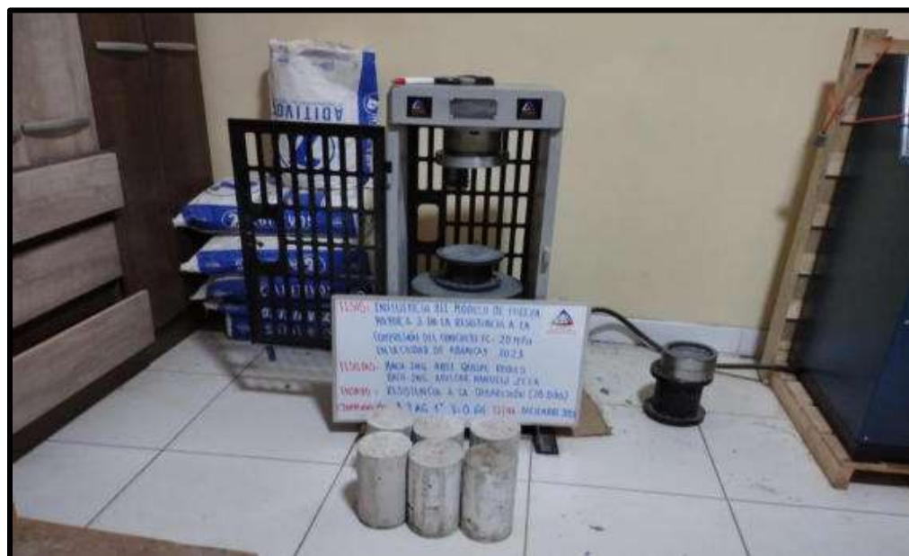
Figura 93 — Especímenes cilíndricos de concreto para ensayo de compresión en 28 días de MF 3.2 con AG: 1" V=0.64
