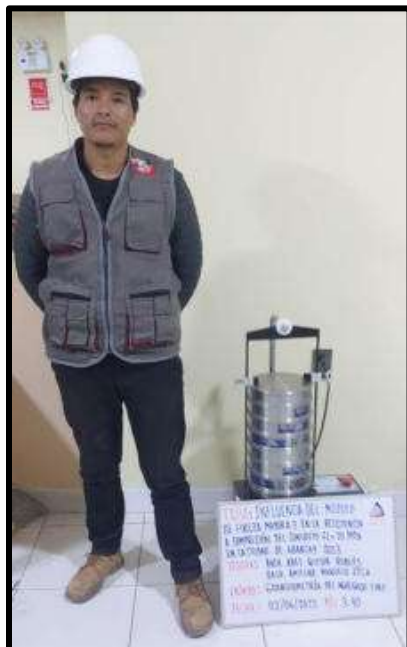
Figura 80 — Ensayo de granulometría por tamizado agregado fino MF 3.40
