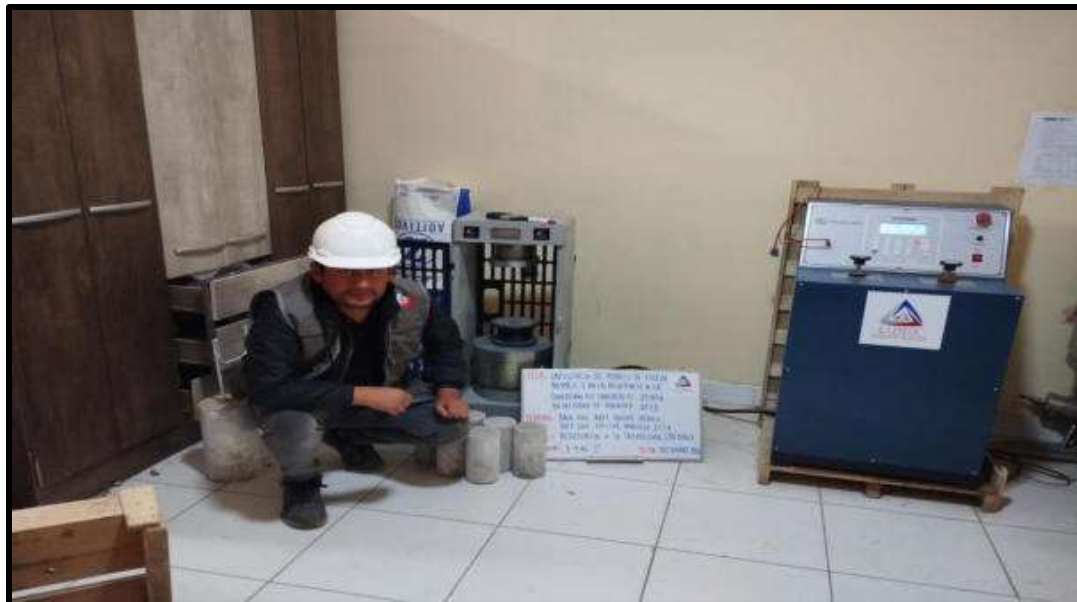
Figura 96 — Especímenes cilíndricos de concreto para ensayo de compresión en 28 días de MF 3.4 con AG: 1" V=0.64
