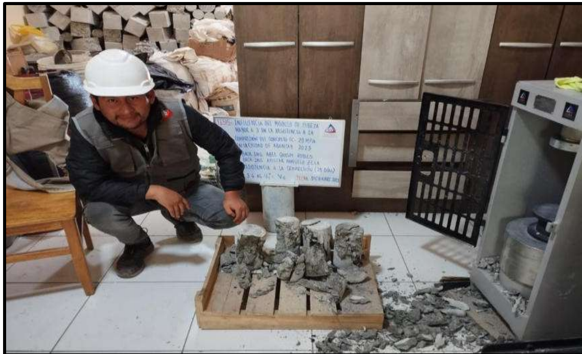
Figura 106 — Resistencia a la compresión en 28 días de MF 3.6 con AG: 3/4" V=0.58
