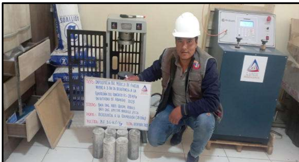
Figura 99 — Especímenes cilíndricos de concreto para ensayo de compresión en 28 días de MF 3.6 con AG: 1" V=0.64
