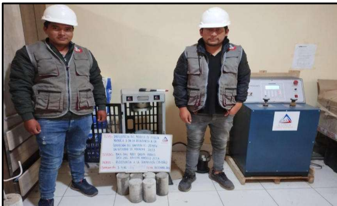
Figura 95 — Especímenes cilíndricos de concreto para ensayo de compresión en 28 días de MF 3.4 con AG: 3/4" V=0.58
