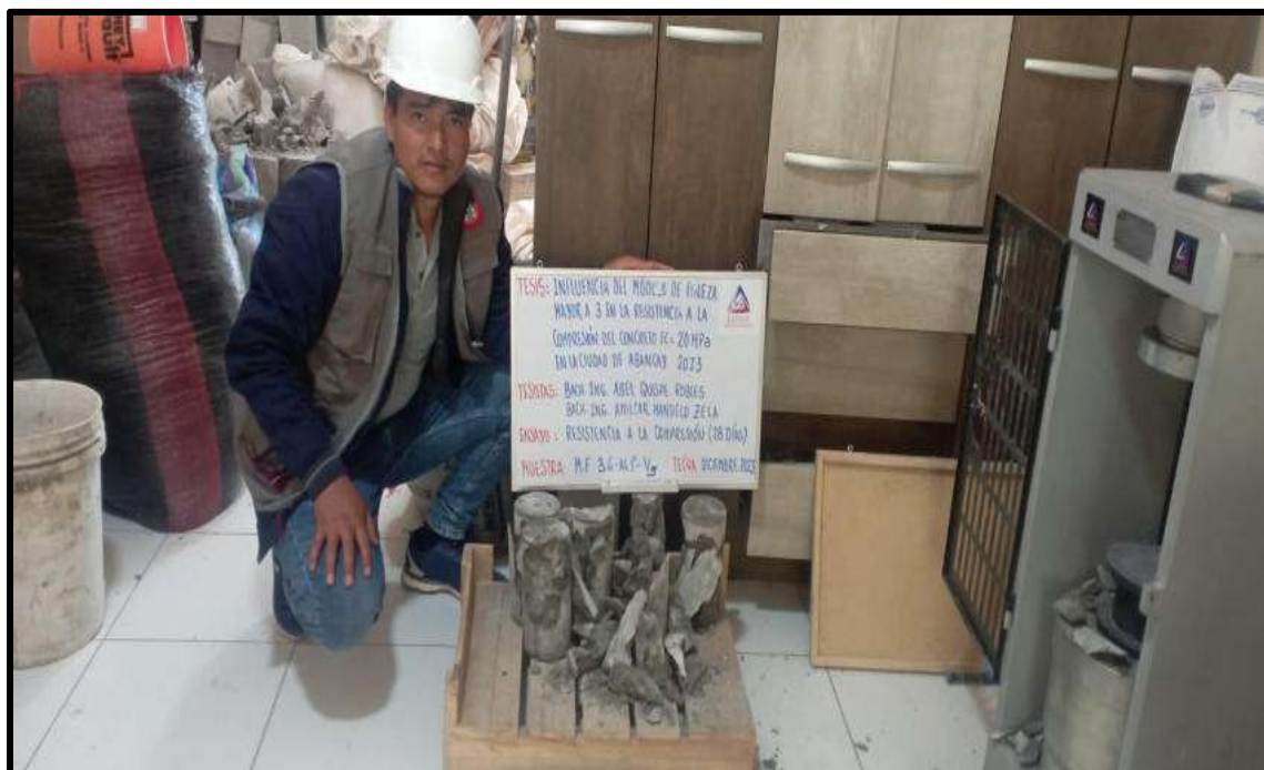
Figura 107 — Resistencia a la compresión en 28 días de MF 3.6 con AG: 1" V=0.64
