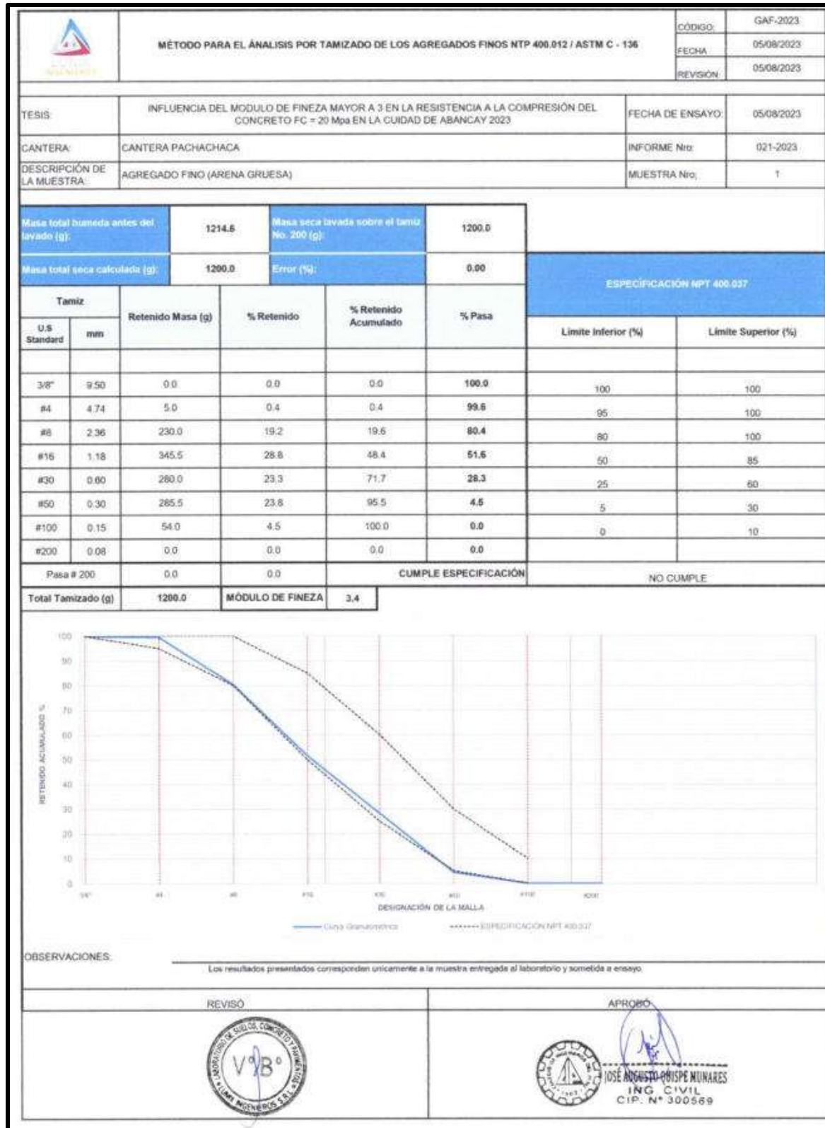
Figura 19 — Resultados de ensayo de granulométrico de agregado fino módulo fino 3.40
