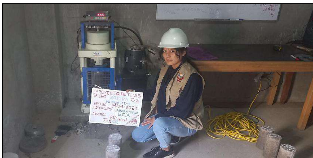
Figura 86 — Rotura de testigos de concreto con prensa hidráulica G 5
