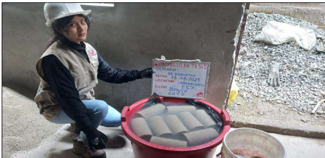
Figura 72 — Curado de los testigos concreto del grupo experimental 1 (G 1 )
