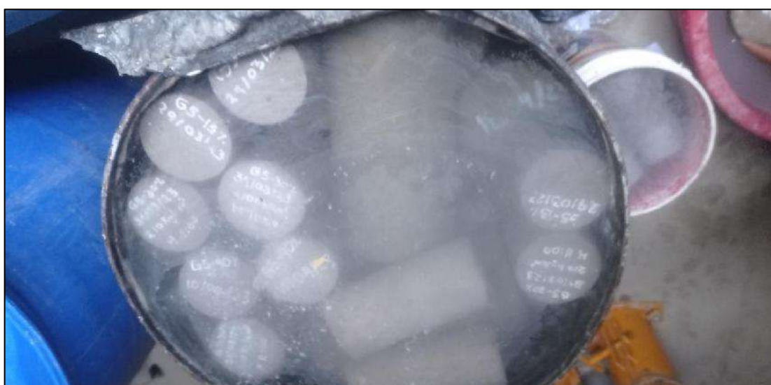
Figura 73 — Curado de los testigos de concreto
