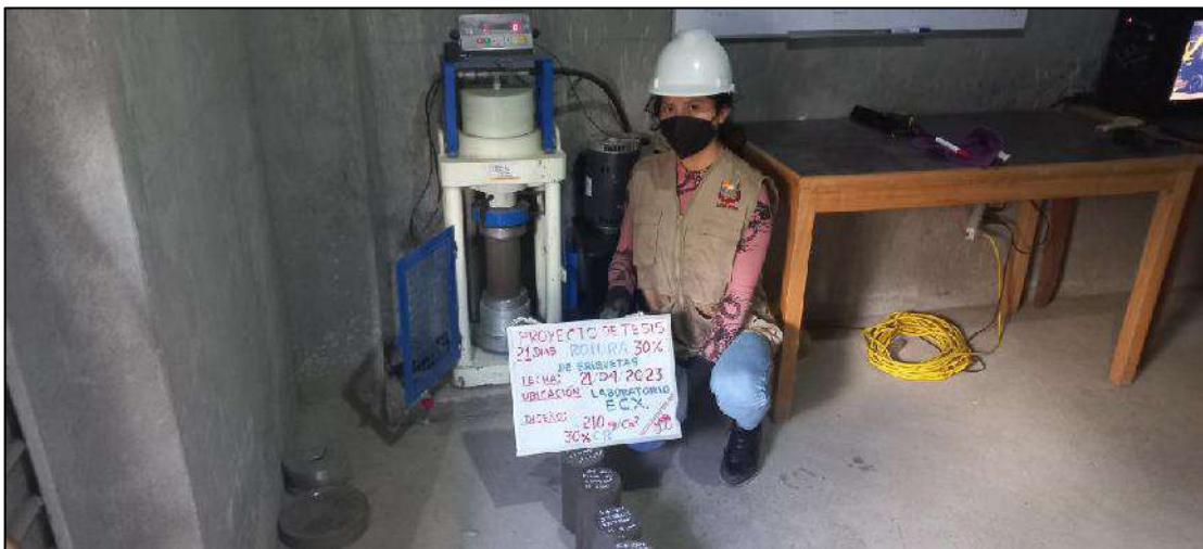
Figura 82 — Rotura de testigos de concreto con prensa hidráulica G 3
