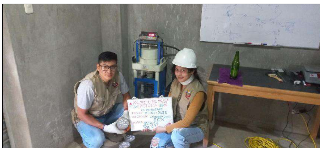
Figura 80 — Rotura de testigos de concreto con prensa hidráulica G 3
