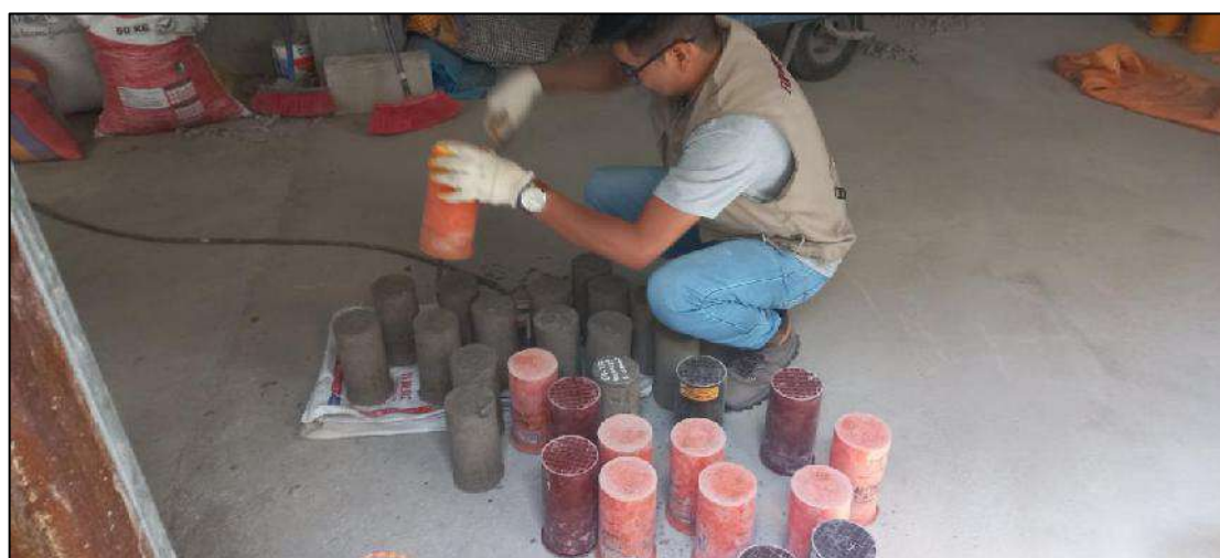
Figura 70 — Desencofrado de los testigos de concreto
