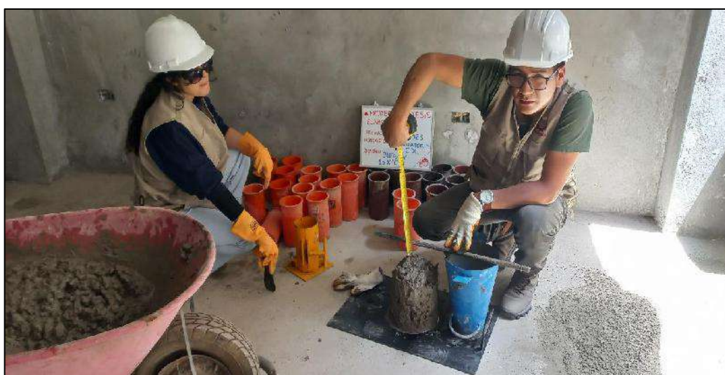
Figura 59 — Verificación del asentamiento mediante el cono de Abrams
