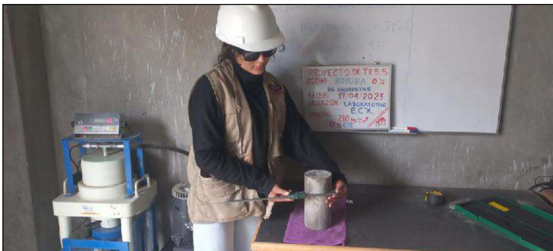
Figura 75 — Verificación del diámetro de los testigos de concreto G 1
