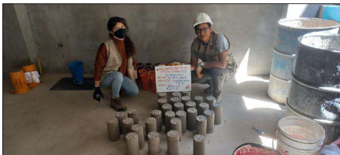
Figura 71 — Escritura de la nomenclatura para los testigos de concreto
