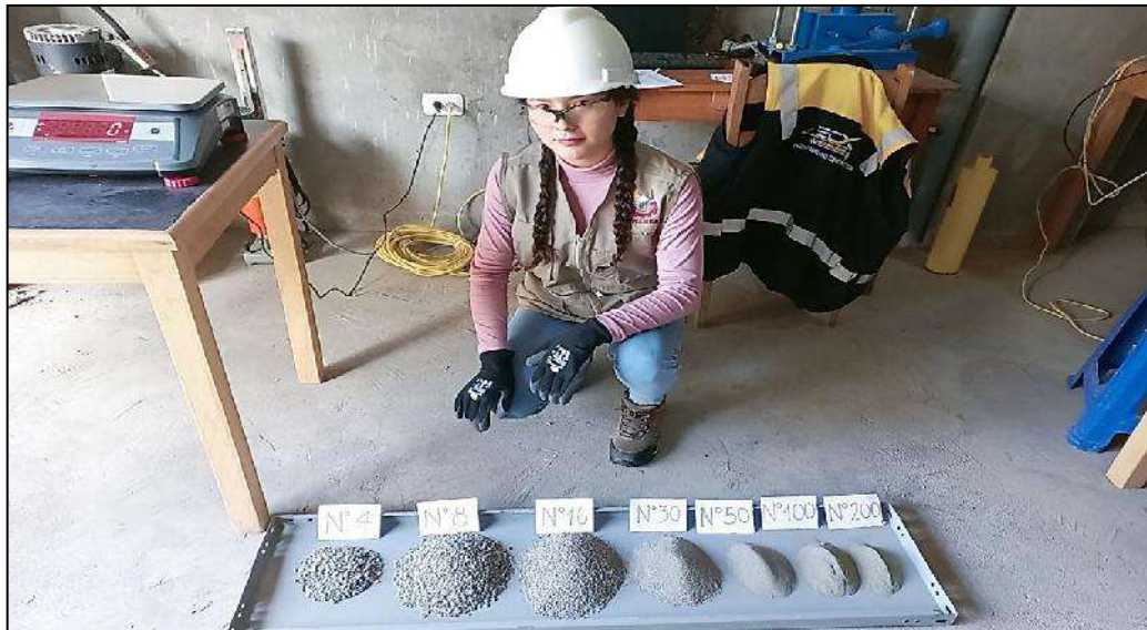
Figura 51 — Verificación de la distribución de tamaños del agregado
