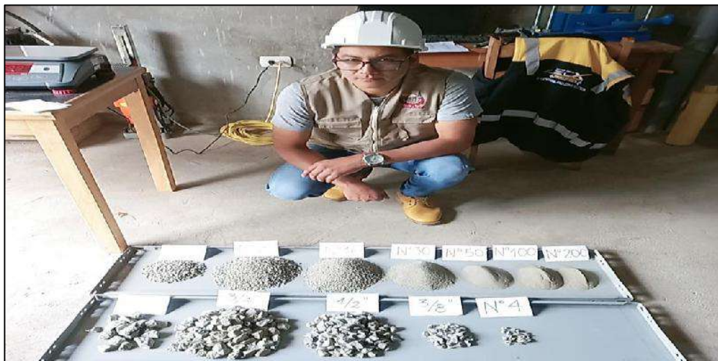
Figura 52 — Distribución de tamaños del agregado grueso
