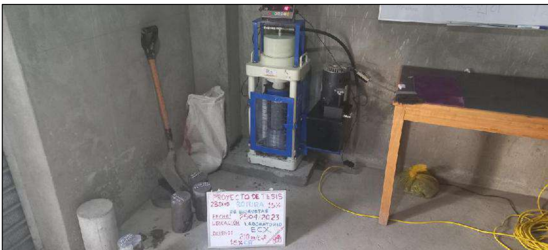
Figura 83 — Rotura de testigos de concreto con prensa hidráulica G 2
