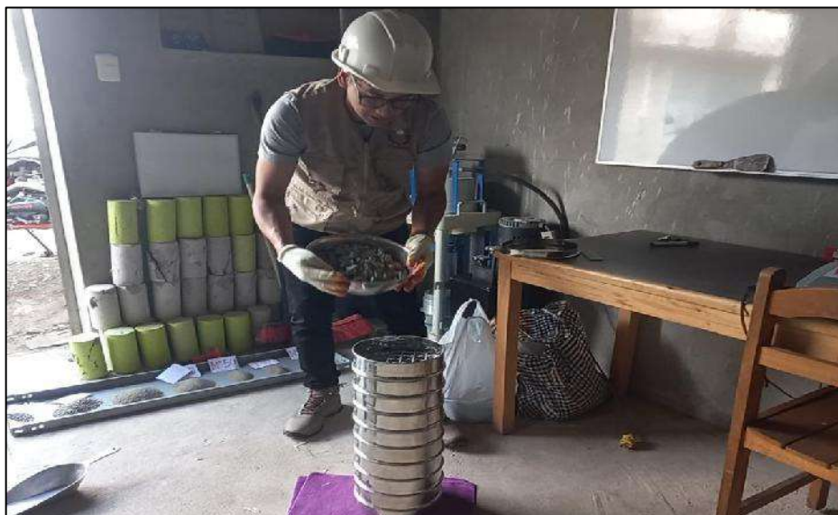
Figura 49 — Tamizado de agregados
