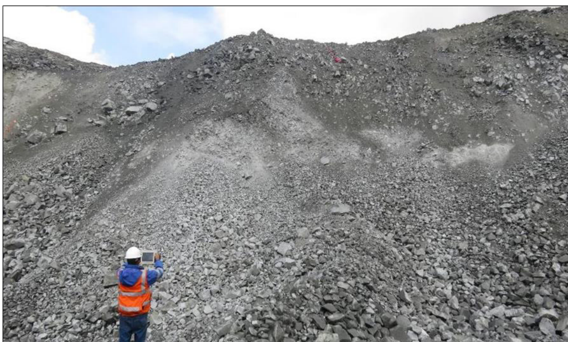
Fotografía 3-23: Toma de muestras en frente de carguío con el equipo “Porta Metrics”. Fuente: Asistencia Técnica (ORICA) “Las Bmbas”.
