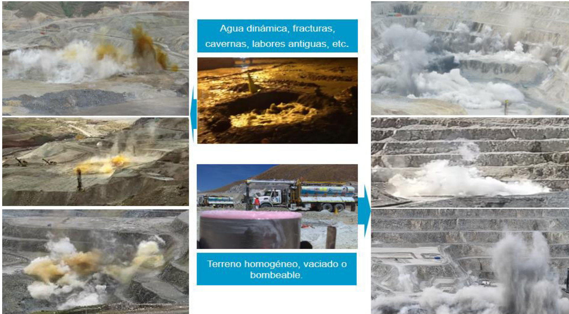
Fotografía 4-29: Emisión de gases producidos post voladuras “Tajo Ferrobamba”.
