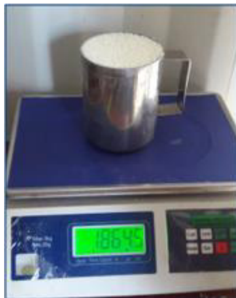
Fotografía 2-11 y Fotografía 2-12: Densidad de la mezcla explosiva “Fortis Mex 60 (HA 64)”. Fuente: Asistencia Técnica (ORICA) “Las Bambas”.
