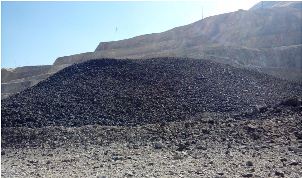
Fotografía A-35: Resultados Fragmentación de rocas con emulsión gasificada. Fuente: Elaboración propia.
