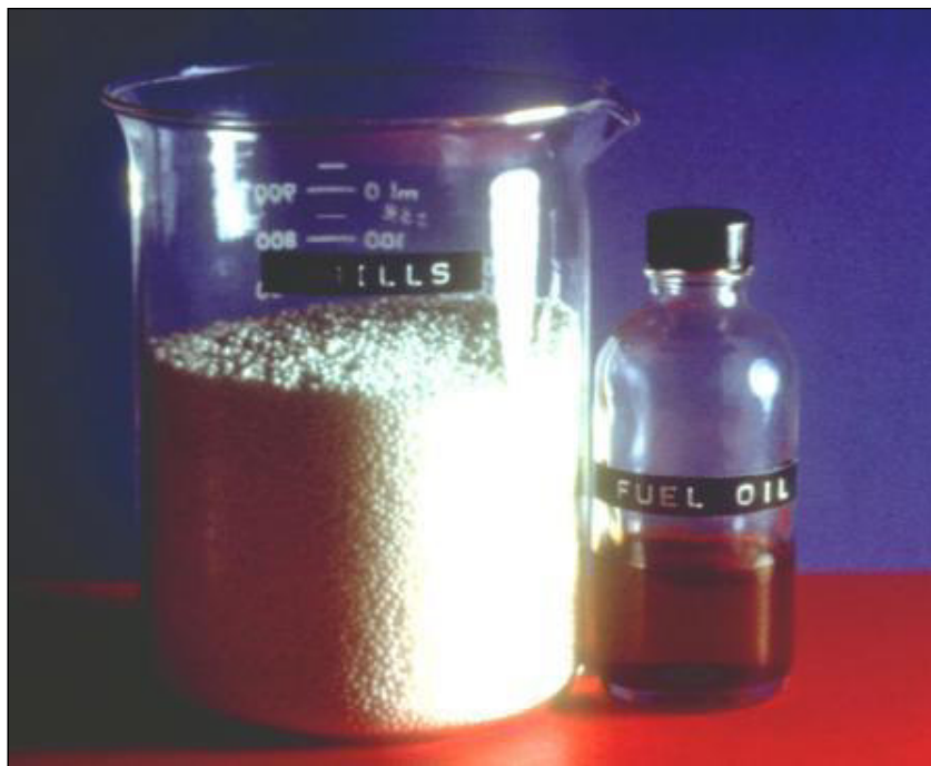
Fotografía 2-14: ANFO (Nitrato de Amonio 94% combustible derivado de petróleo 6 %). Fuente: Asistencia Técnica (ORICA) “Las Bambas”.
