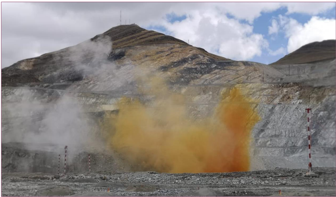
Fotografía 2-13: Gases nitrosos post voladura de la mezcla explosiva “Fortis Mex 60 (HA 64)”. Fuente: Propia.
