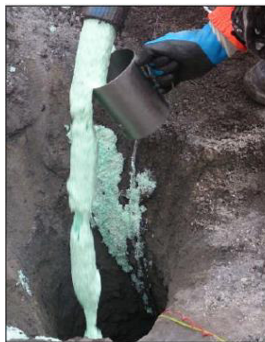
Fotografía 3-15 y Fotografía 3-16: Toma de muestra explosiva (Fortis Extra 65/35) en vaso volumétrico. Fuente: Asistencia Técnica (ORICA) “Las Bombas”.
