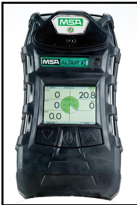
Fotografía 3-28: Monitoreo de gases con el equipo “MSA ALTAIR 5X”. Fuente: Asistencia Técnica (ORICA) “Las Bambas”.
