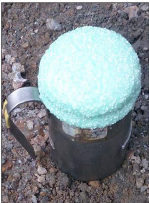
Fotografía 3-19 y Fotografía 3-20: Pesado de la muestra explosiva después de limpiar el material. Fuente: Asistencia Técnica (ORICA) “Las Bambas”.
