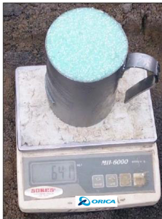
Fotografía 3-19 y Fotografía 3-20: Pesado de la muestra explosiva después de limpiar el material. Fuente: Asistencia Técnica (ORICA) “Las Bambas”.
