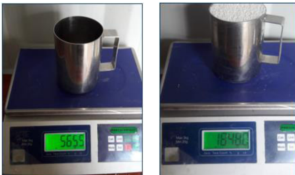
Fotografía 2-9 y Fotografía 2-10: Densidad de la mezcla explosiva “Fortan Mex 50 (HA 55)”.
