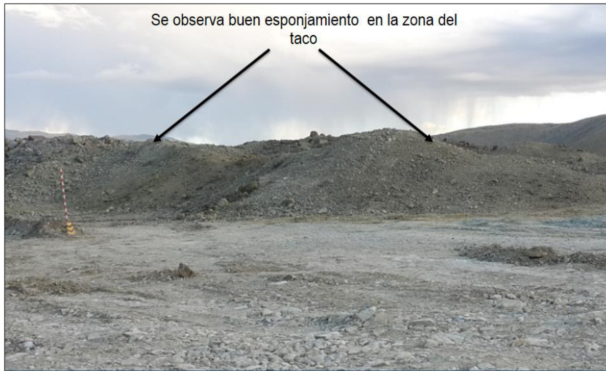
Fotografía 3-26: Resultados de fragmentación “Jahuapaylla Alta 4020-027”.
