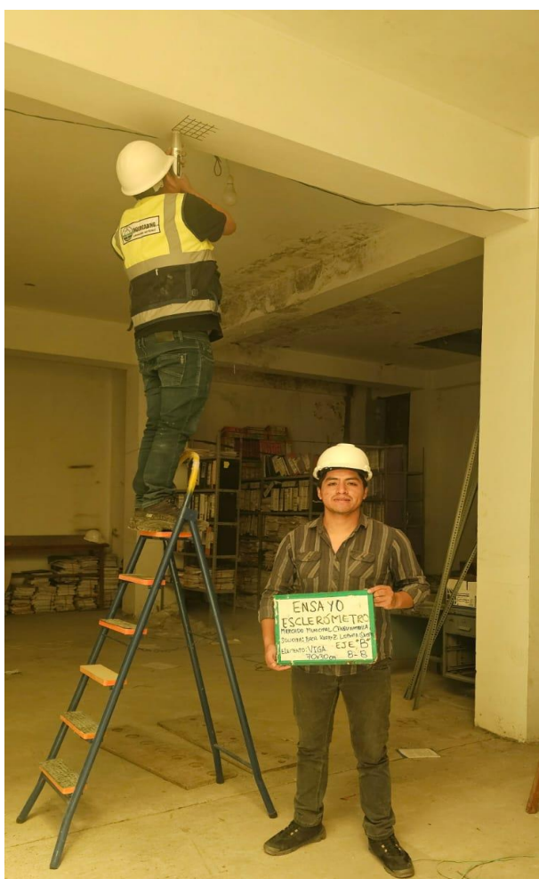
Figura 57 — Ejecución de la Prueba de Esclerometría para la Evaluación de la Resistencia del Concreto en Columnas y vigas
