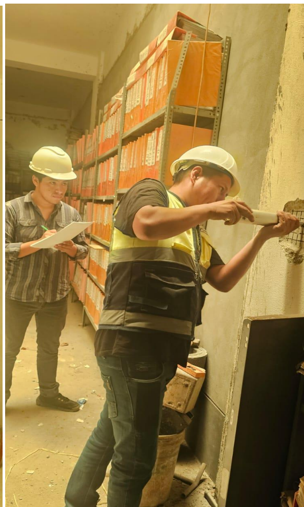
Figura 57 — Ejecución de la Prueba de Esclerometría para la Evaluación de la Resistencia del Concreto en Columnas y vigas
