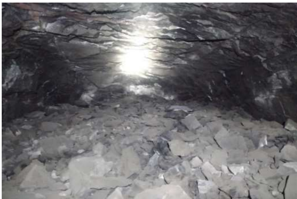
Figura 39 — Resultado del disparo con la nueva malla
