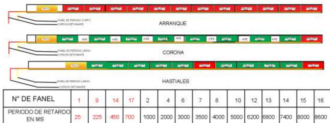
Figura 11 — Distribución lineal del explosivo en el taladro
