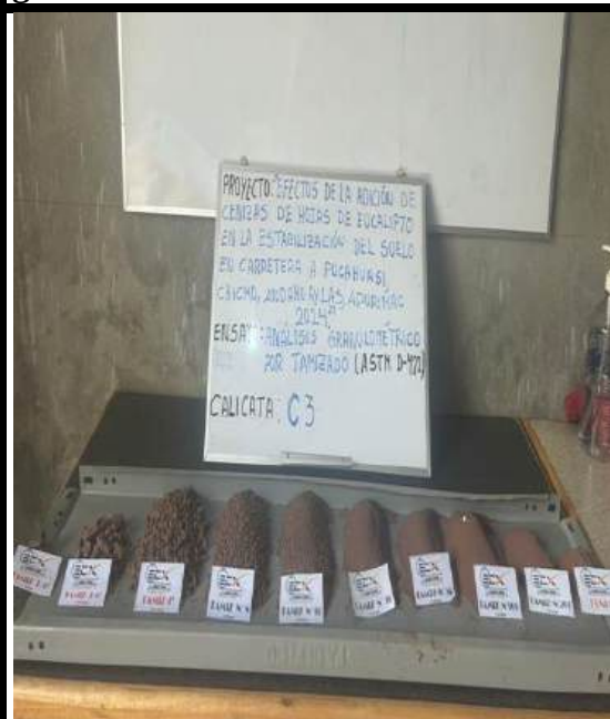
Figura 141 — Análisis granulométrico por tamizado de la calicata 3
