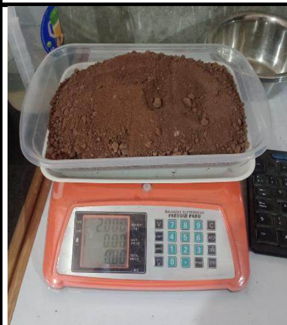
Figura 146 — Pesado de la muestra para ensayo Proctor Modificado
