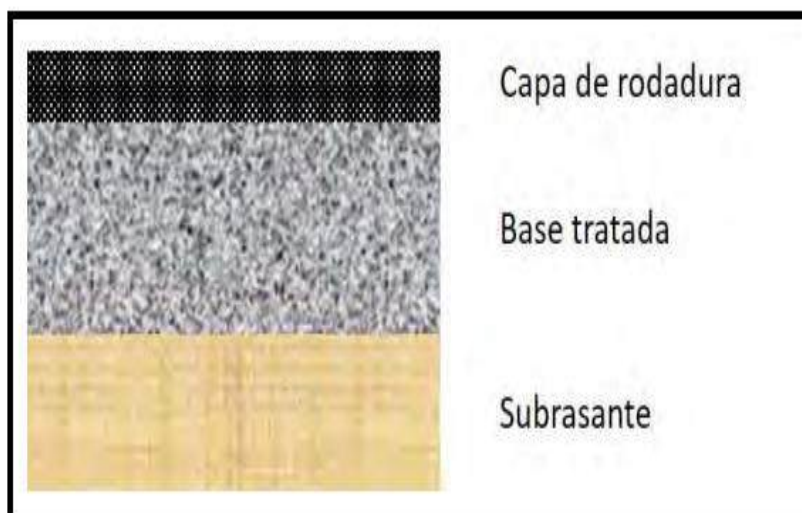
Figura 9 — Esquema de un pavimento semirrígido
