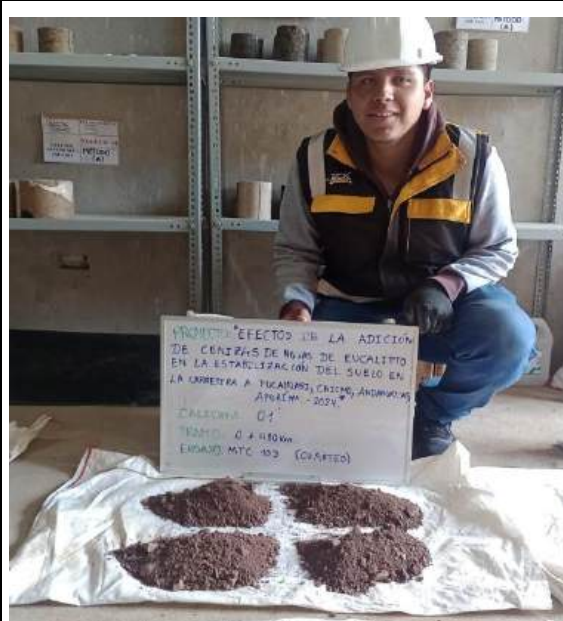
Figura 138 — Cuarteo de muestra de la calicata 1 para ensayo de granulometría
