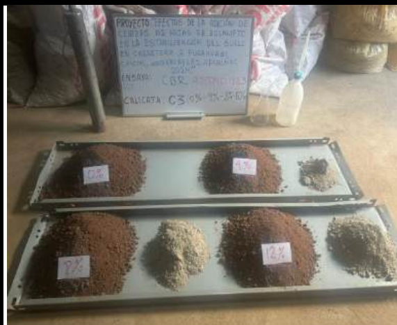
Figura 155 — Suelo con cenizas de hojas de Eucalipto para CBR; calicata 3
