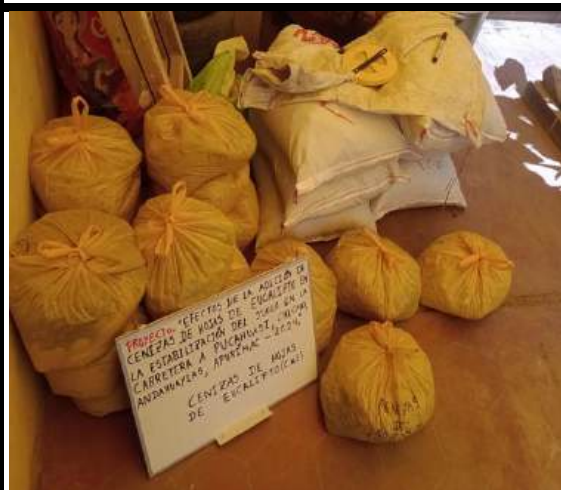
Figura 134 — Acoplo de las muestras antes de ser llevadas al laboratorio Muestra de suelo por calicata: 100kg Muestra de cenizas por calicata: 30kg
