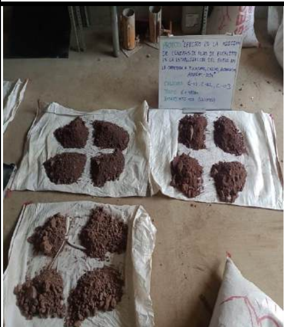
Figura 140 — Cuarteo de las 3 calicatas para su granulometría
