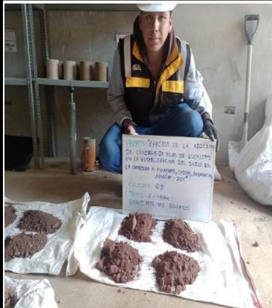
Figura 139 — Cuarteo de muestra de la calicata 3 para ensayo de granulometría
