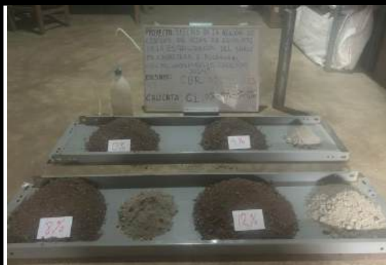
Figura 153 — Suelo con cenizas de hojas de Eucalipto para CBR; calicata 1
