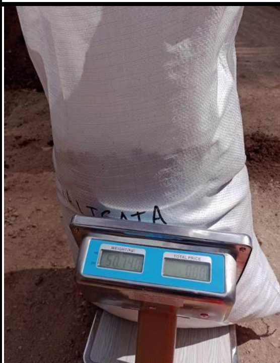
Figura 127 — Extracción y pesado de la muestra de la calicata 1; 50Kg de tierra a 1,5m de profundidad.
