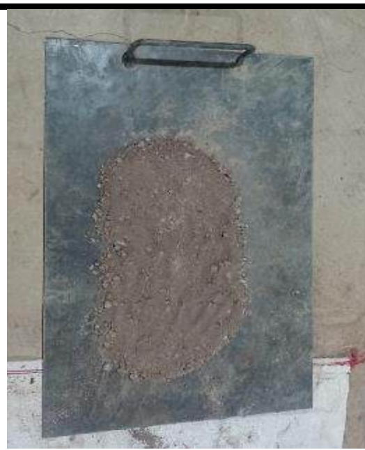
Figura 147 — Suelo más adición de polvo de cenizas de hojas de eucalipto al 8%
