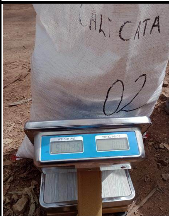
Figura 126 — Extracción y pesado de la muestra de la calicata 2; 50Kg de tierra a 1,5m de profundidad.
