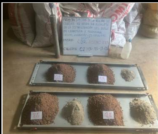
Figura 154 — Suelo con cenizas de hojas de Eucalipto para CBR; calicata 2
