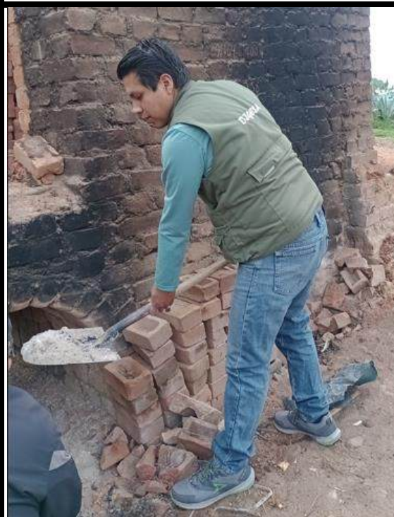
Figura 131 — Recolección de cenizas de hojas de Eucalipto del horno de una ladrillera de Chaccamarca-Andahuaylas
