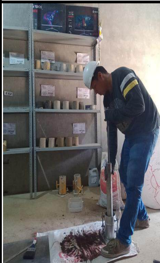
Figura 149 — Compactación del suelo para Proctor Modificado
