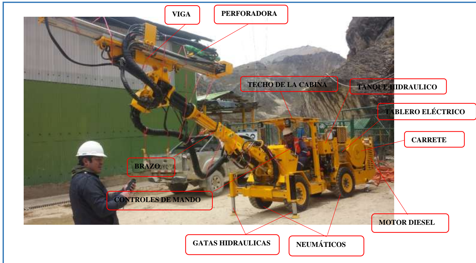
Fotografía 1. Partes principales del Mini Jumbo Muki.
