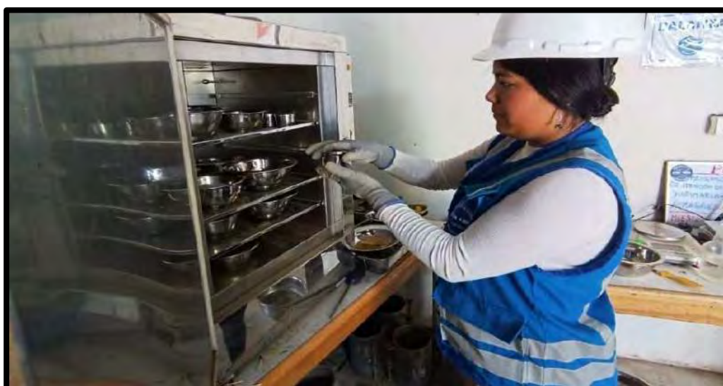
Figura 7 — Proceso de secado de las muestras en horno temperatura 110 °C
