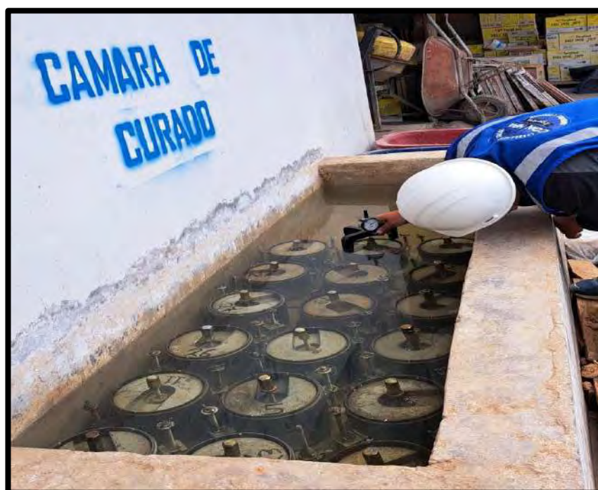
Figura 44 — Lectura de la expansión de los moldes elaborados en el ensayo de C.B.R. con adición de 5 %, 15 % y 25 % de RFC
