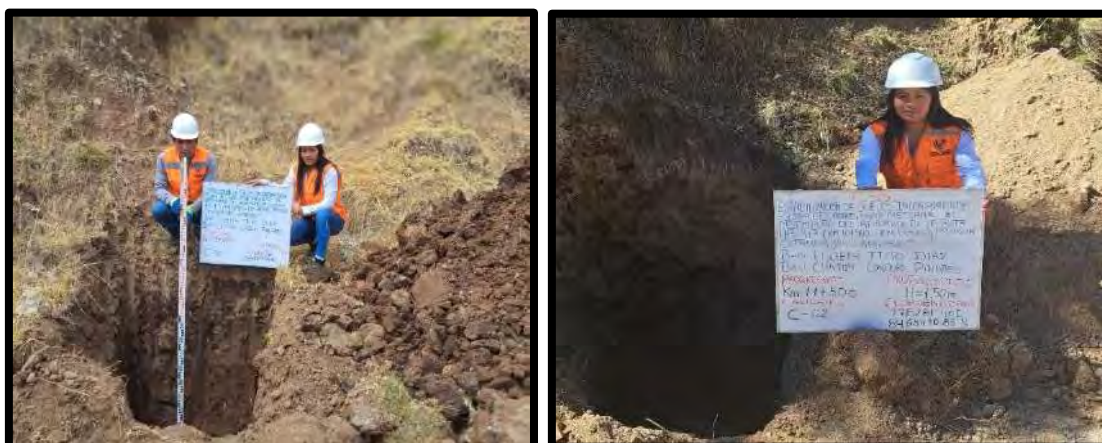
Figura 33 — Extracción de la muestra calicata 01 (margen derecho h = 1.5 m) y calicata 02 (margen derecho h = 1.5 m)
