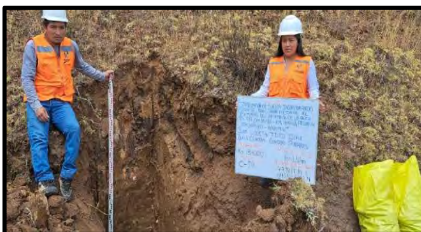
Figura 37 — Extracción de la muestra calicata 09 (margen izquierdo h = 1.5 m)
