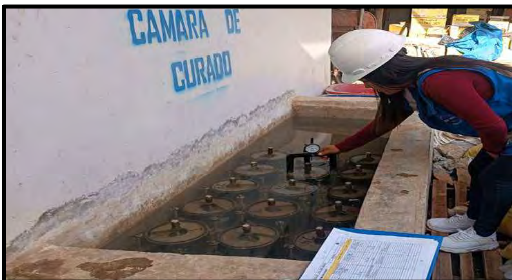
Figura 10 — Ensayo de C.B.R. de las muestras de suelo natural más la incorporación de RFC en un 5 %, 15 % y 25 %.
