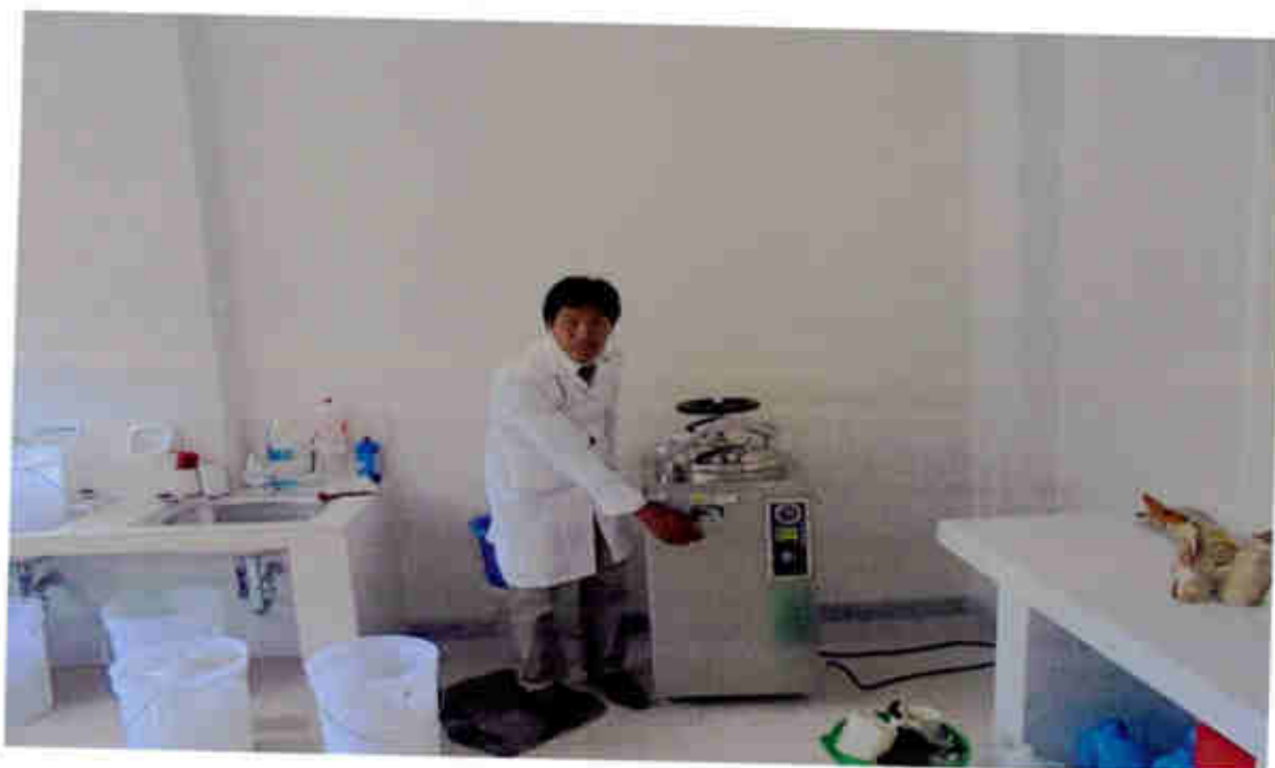
Figura 22. Esterilización de materiales para el procesamiento de muestras de agua de consumo humano en el Laboratorio de la Dirección Regional de Salud Ambiental.
