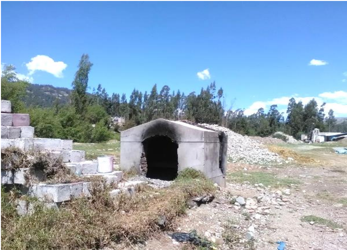
Figura 13. Horno de cremación de carcasas, carne y menudencias declarados no aptos para consumo humano.
