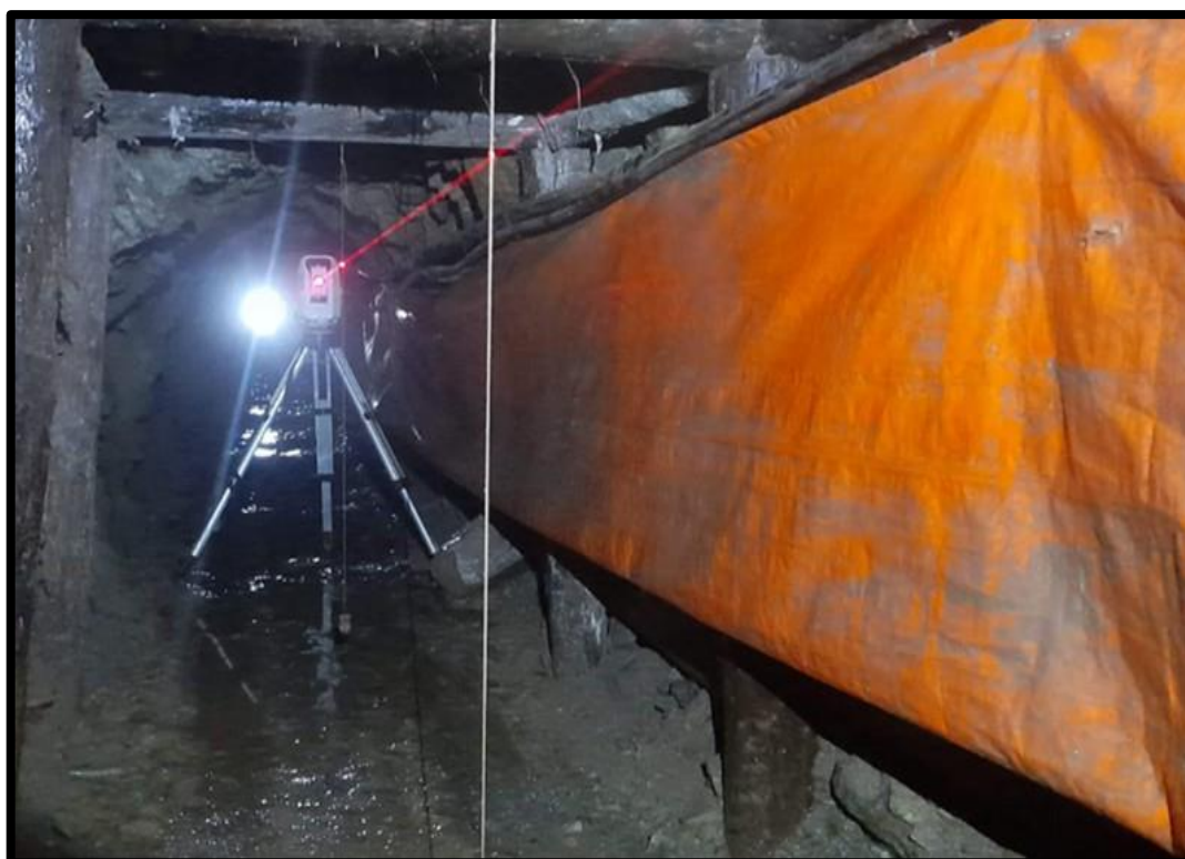
Figura 32 — Levantamiento topográfico con equipo láser en el interior de la mina
