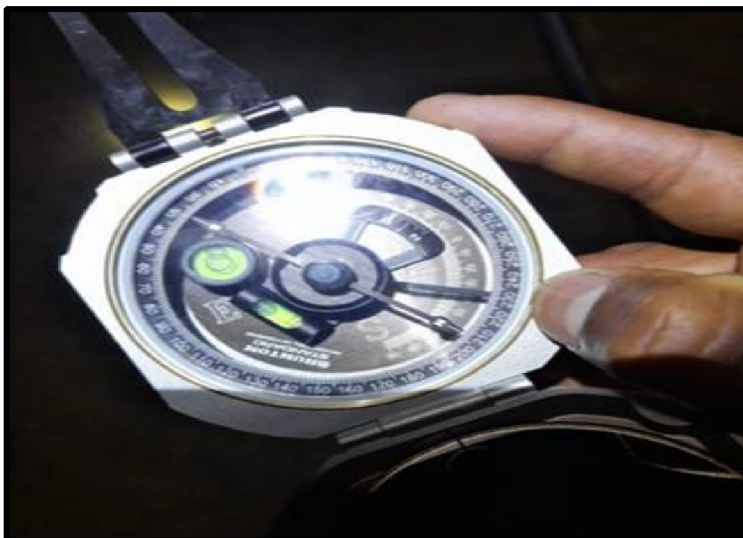
Figura 24 — Medición de orientación con brújula minera
