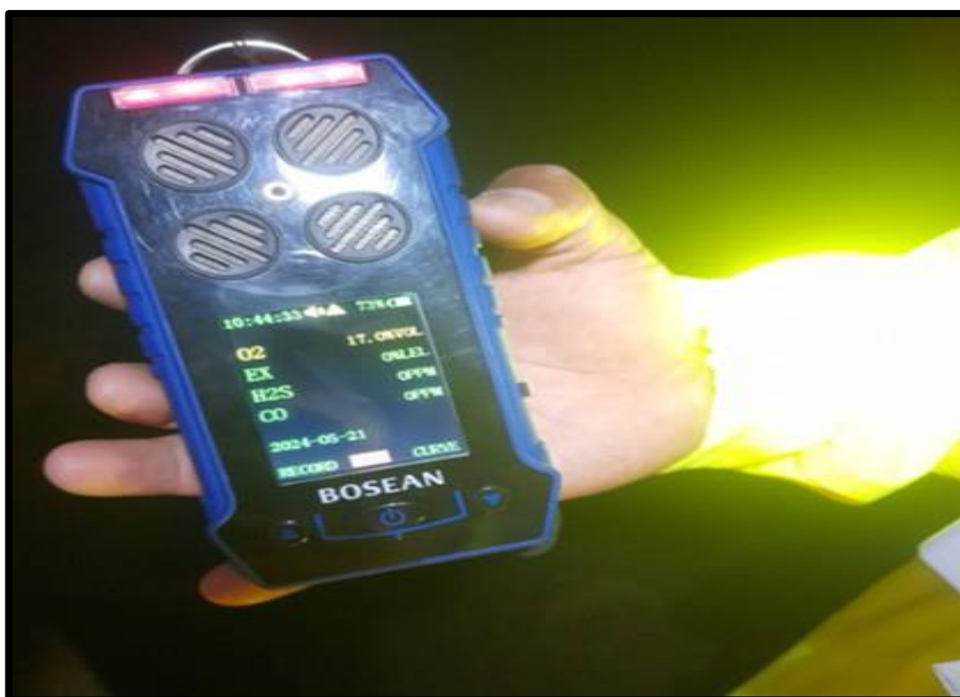
Figura 30 — Medición de gases en el interior de la mina
