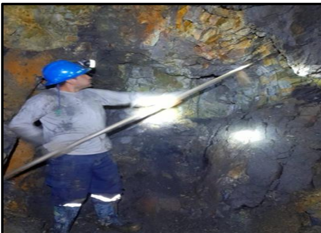
Figura 21 — Inspección del macizo rocoso en el interior de la mina
