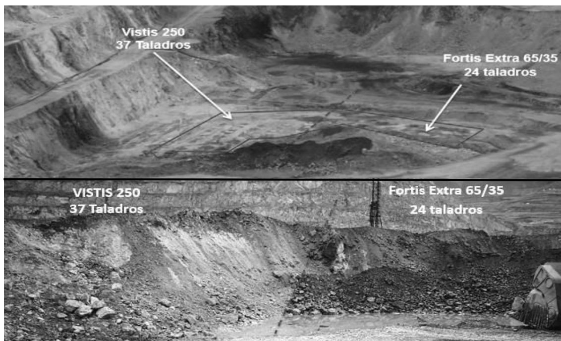
Figura 137: 8vo Analisis de fragmentacion Proyecto: 3780-042-01 (P80= 4.37 pulg.; < 1 pulg. = 49.67%)
