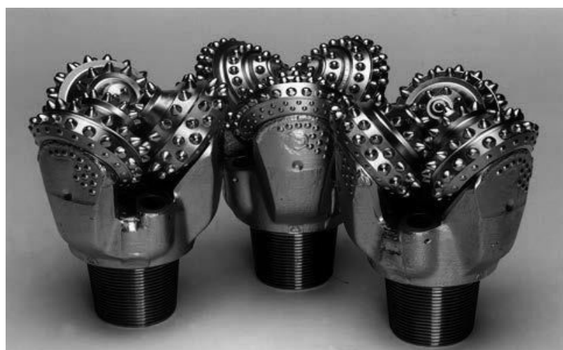
Figura 27. Triconos con inserto de tungsteno. Fuente: Perforación y voladura de rocas en minería (Madrid 2013)
