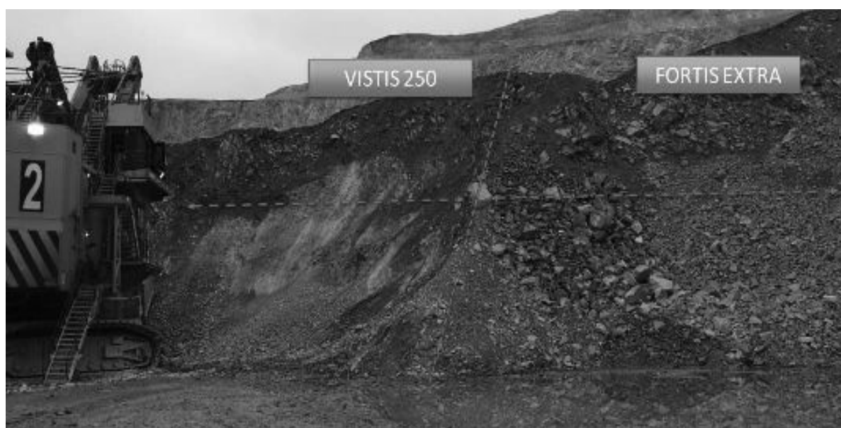
Figura 106. Frente de minado y diferencia de fragmentacion sgun mezcla explosiva utilizada. Fuente: Orica Mining Services Perú S.A.
