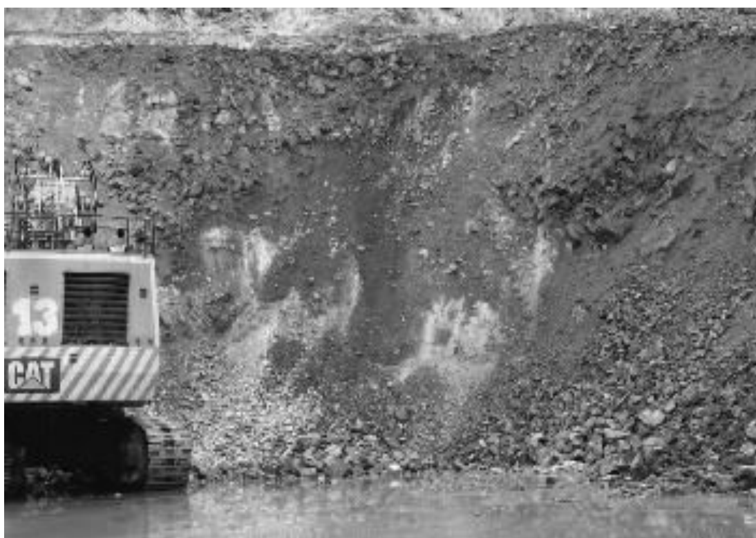
Figura 136: 2do Analisis de fragmentacion Proyecto: 3810-072-03 (P80 = 3.58pulg.; < 1 pulg. =40.1%)
