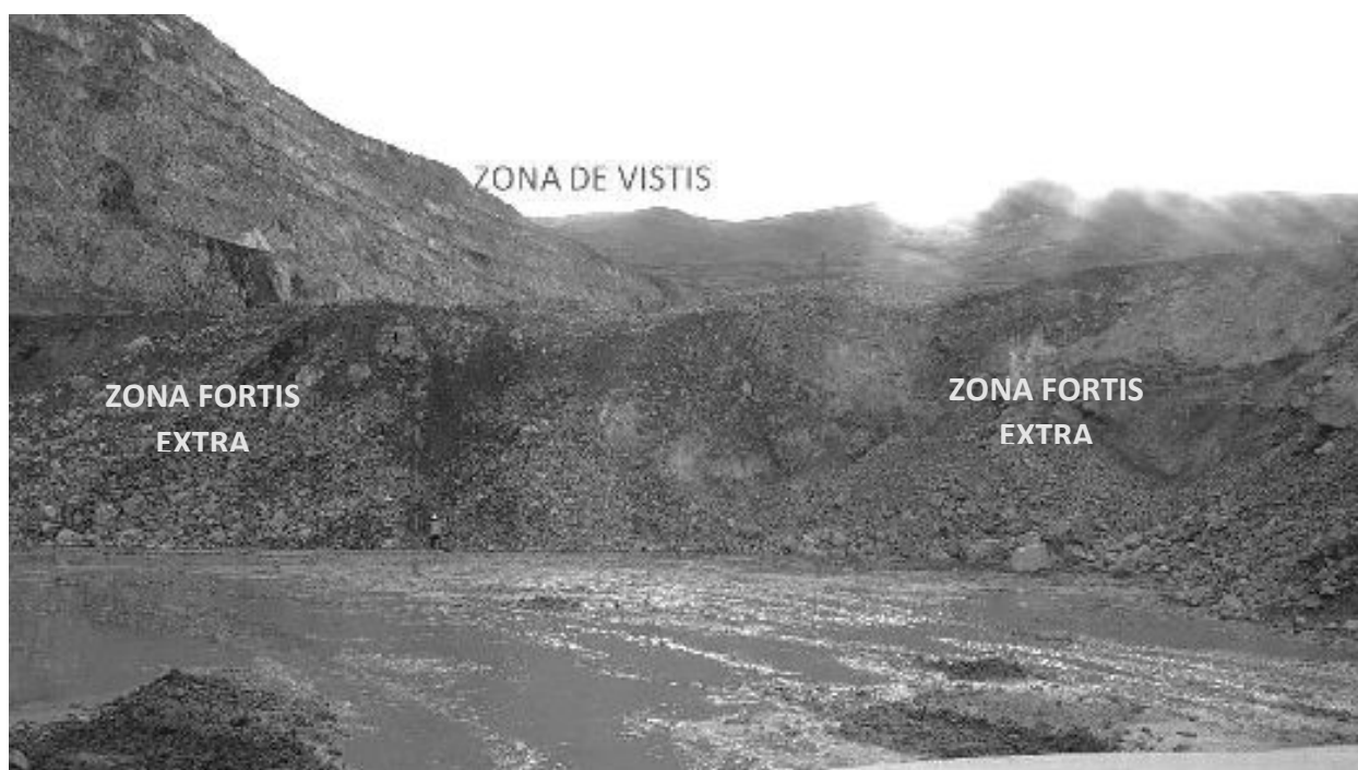
Figura 119. Delimitación de la zona fragmentada con explosivo VISTIS 250 y FORTIS EXTRA Fuente: Elaboración propia.
