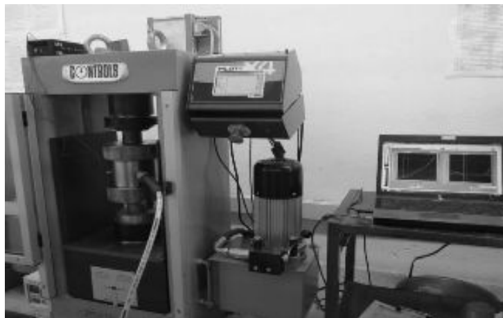
Figura 14. Equipo de ensayo uniaxial Fuente: Ingetec
