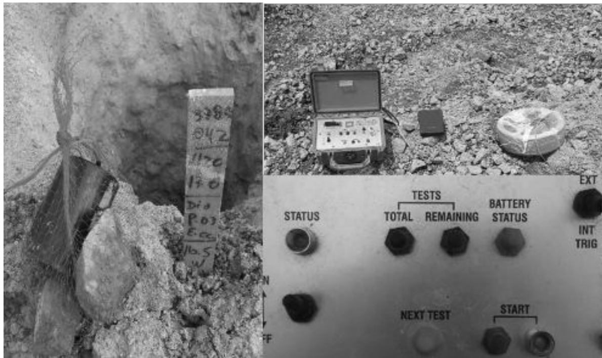
Figura 74. Instalación de Equipo Micro Trap. Fuente: Elaboracion propia.
