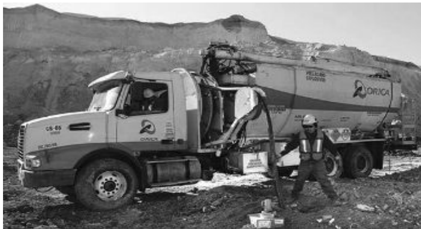
Figura 41. carguío de taladros con MMU Fuente: Orica mining services Perú S.A
