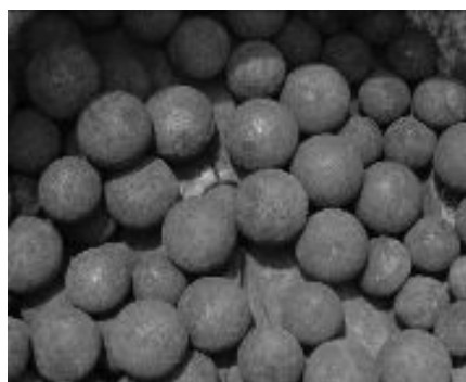
Figura 66. Bolas de acero como medio de molienda.
