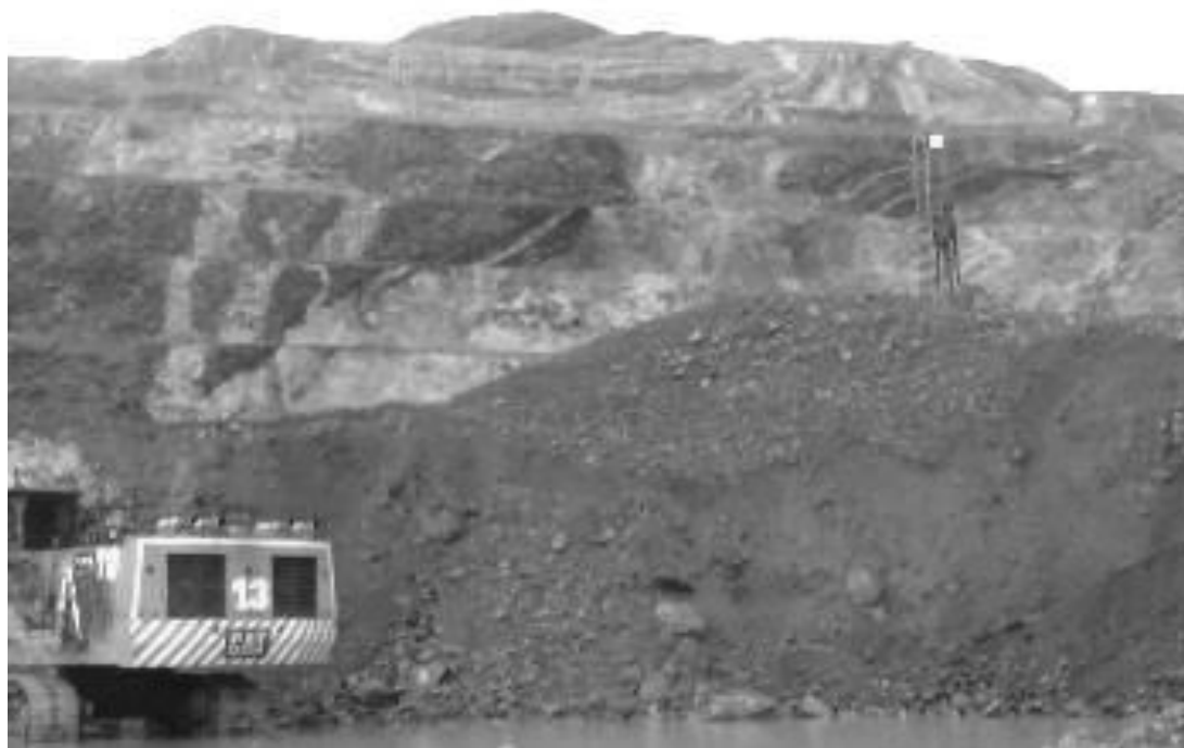
Figura 135: 1er analisis de fragmentacion proyecto :3810-073-03 (P80 = 2.24 pulg.; < 1 pulg.=50.6%)
