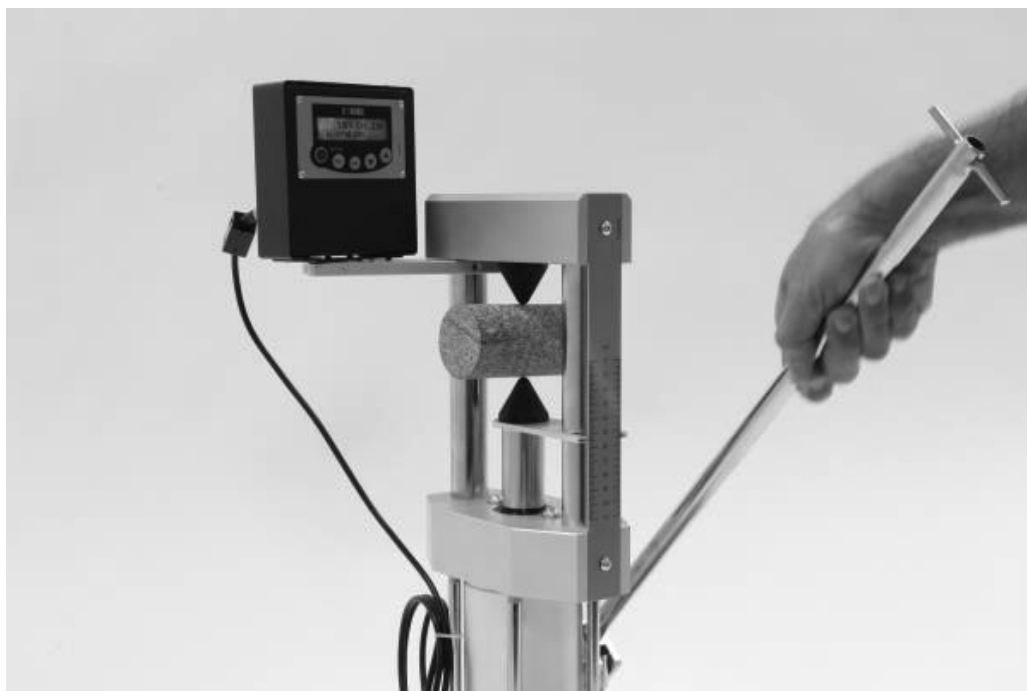
Figura 16. Ensayo de carga puntual mediante la prensa Franklin
