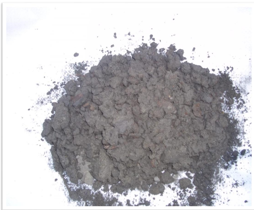
Fotografía N°08: muestra B después de ser oxidada por método directo
