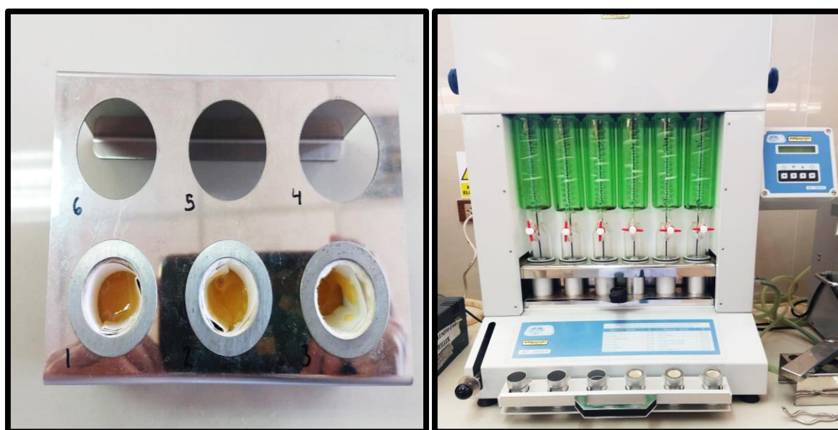
Foto 6: Determinación de grasas por Soxhlet
