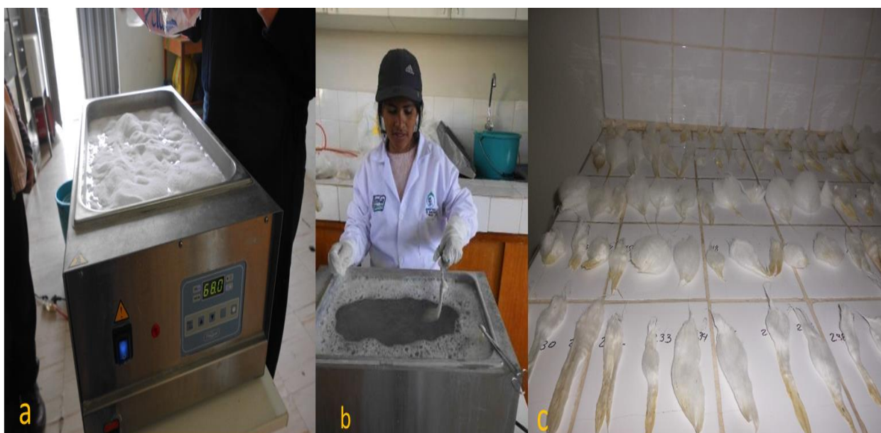
Figura 13. Preparado de agua en baño térmico a t 68°C y añadiendo detergente no enzimático al agua caliente (a), lavado de la muestras de fibra de alpaca (b) y secado de mechas de fibra (c).
