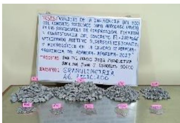
Figura 28 — Ensayo Análisis granulométrico de agregados gruesos y finos
