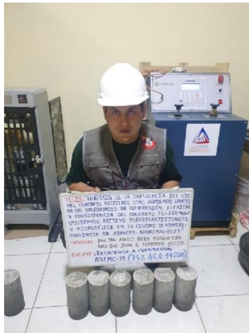
Figura 107 — Ensayo de resistencia a la compresión del GE2 a los 14 días
