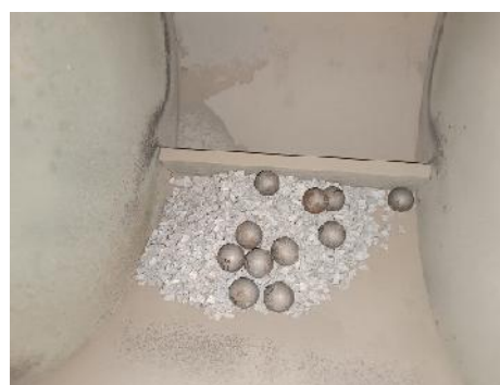
Figura 32 — Ensayo de máquina de Los Ángeles
