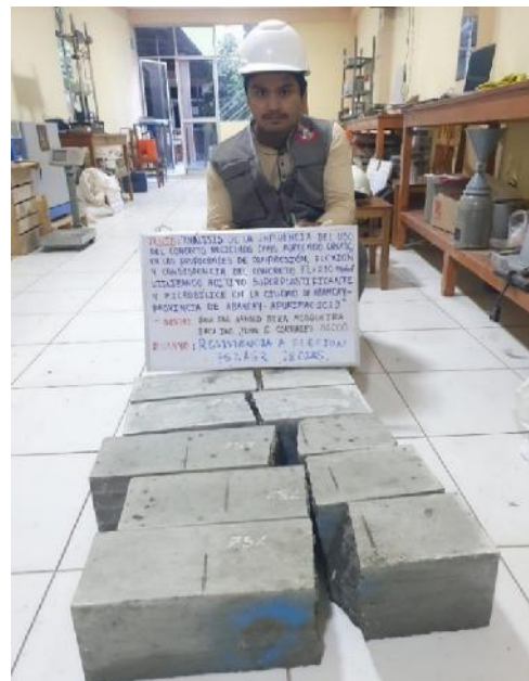
Figura 108 — Ensayo de resistencia a la flexión del GE2 a los 14 días
