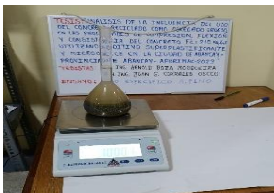
Figura 31 — Ensayo de gravedad específica y absorción de agregados finos
