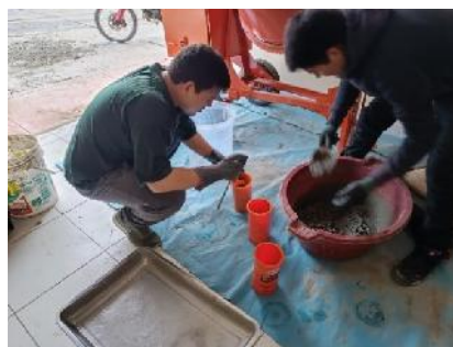
Figura 42— Elaboración de testigos cilíndricos
