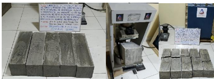
Figura 46 — Rotura de viguetas de concreto
