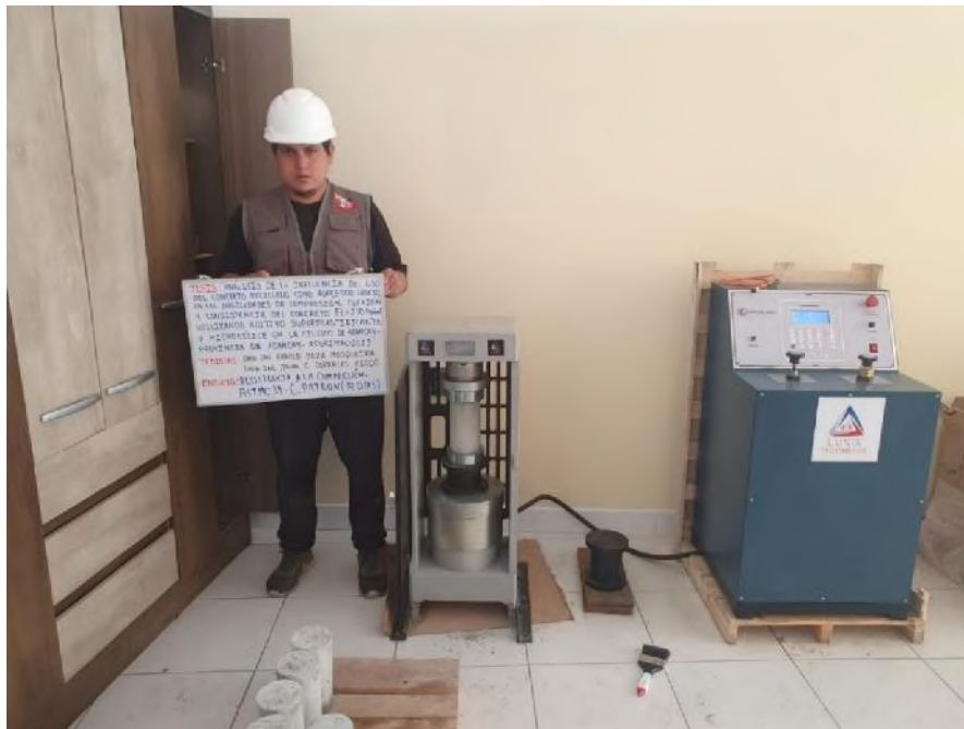
Figura 106 — Ensayo de resistencia a la compresión del GC a los 14 días
