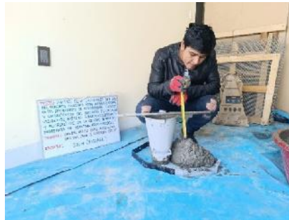
Figura 41 — Prueba de slump
