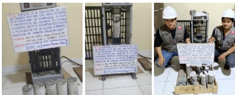
Figura 45 — Rotura de testigos cilíndricos
