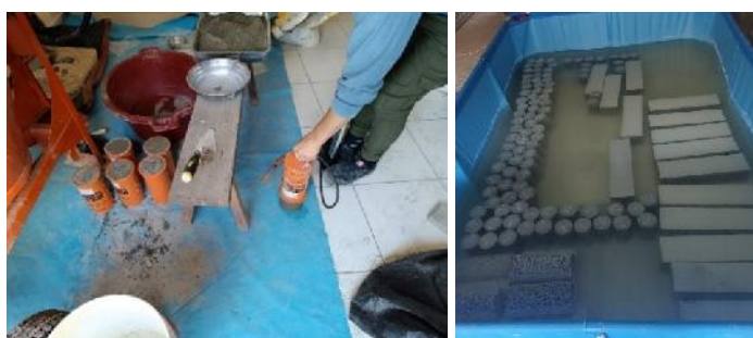
Figura 44 — Desencofrado y curado
