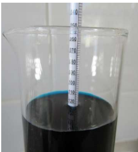
Figura 21. Medición con densímetro nitrito de sodio. Fuente: Elaboración propia.
