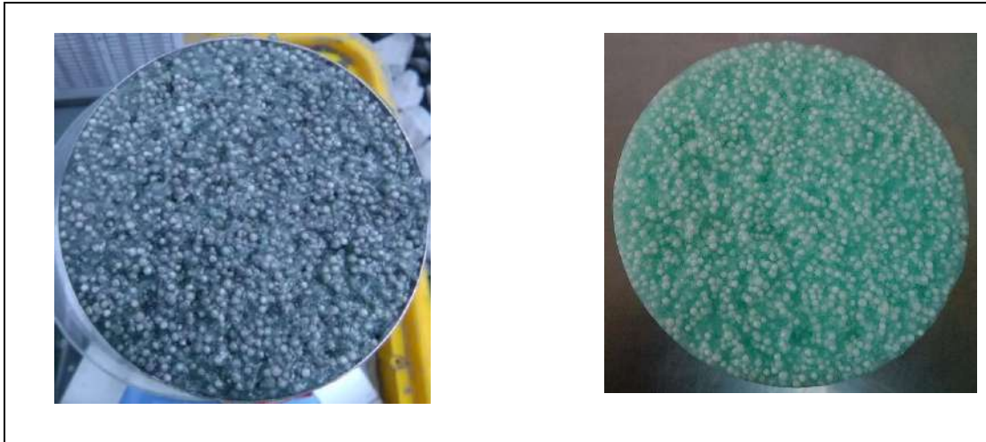
Figura 16. Mezcla óptima de Heavy ANFO 73 con aceite residual gasificado y petróleo. Fuente: (Elaboración propia)
