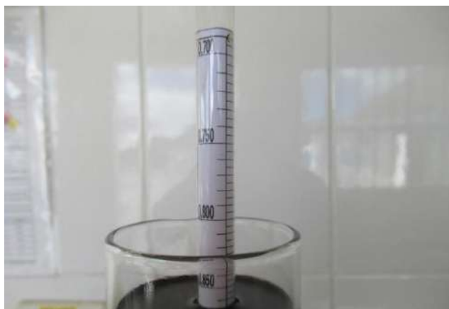
Figura 22. Medición de la densidad del aceite residual Fuente: Elaboración propia
