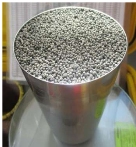
Figura 26. ANFO a base de aceite residual
