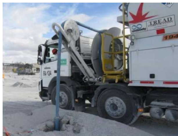
Figura 20. Camión fábrica descargando Heavy ANFO 73 gasificado (Bombeable). Fuente: Elaboración propia.
