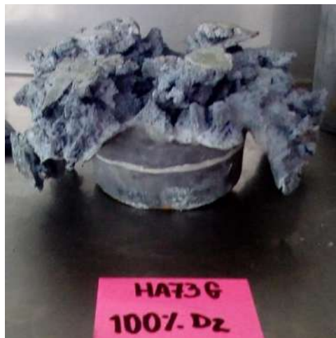
Figura 31. Prueba de macrohess con Heavy ANFO 73 con diésel gasificado.
