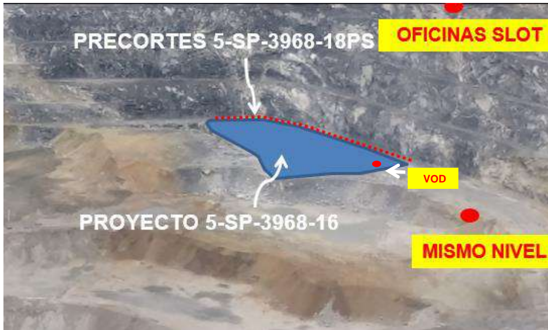
Figura 36. Voladura en fase 5 con Heavy ANFO 73 con petróleo gasificado. Fuente: Asistencia técnica FAMESA EXPLOSIVOS SAC
