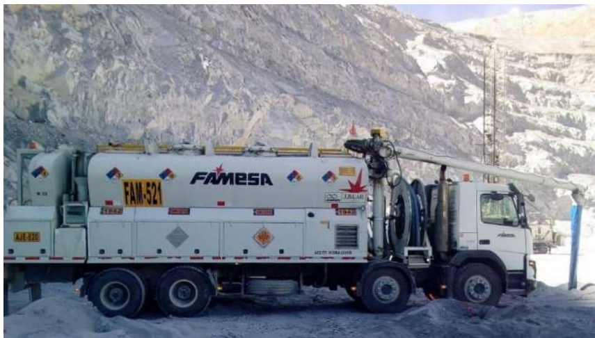
Figura 13. Camión fabrica descargando Heavy ANFO 73 gasificado (vaciabile). Fuente: Elaboración propia.
