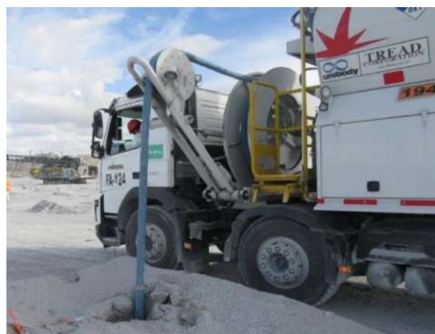
Figura 15. Camión fábrica descargando Heavy ANFO 73 gasificado (bombeable). Fuente: (Elaboración propia).
