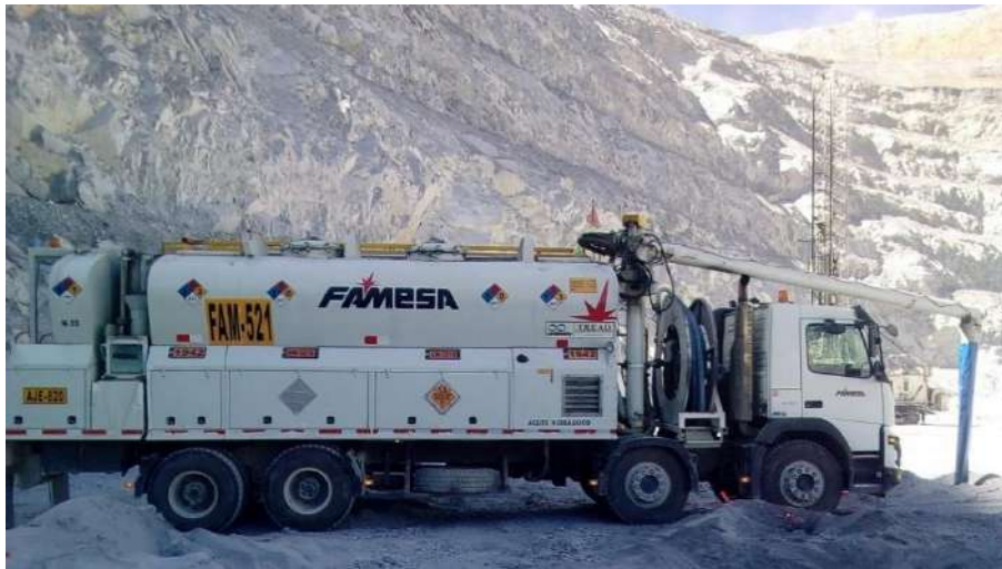
Figura 19. Camión fábrica descargando Heavy ANFO 73 gasificado (vaciable). Fuente: Elaboración propia.
