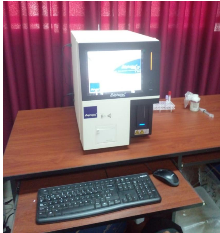
Figura 3. Analizador hematológico automático veterinario
