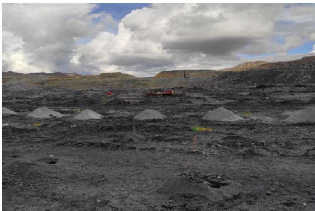
Figura 41 — Malla de perforación lista para realizar carguío.
