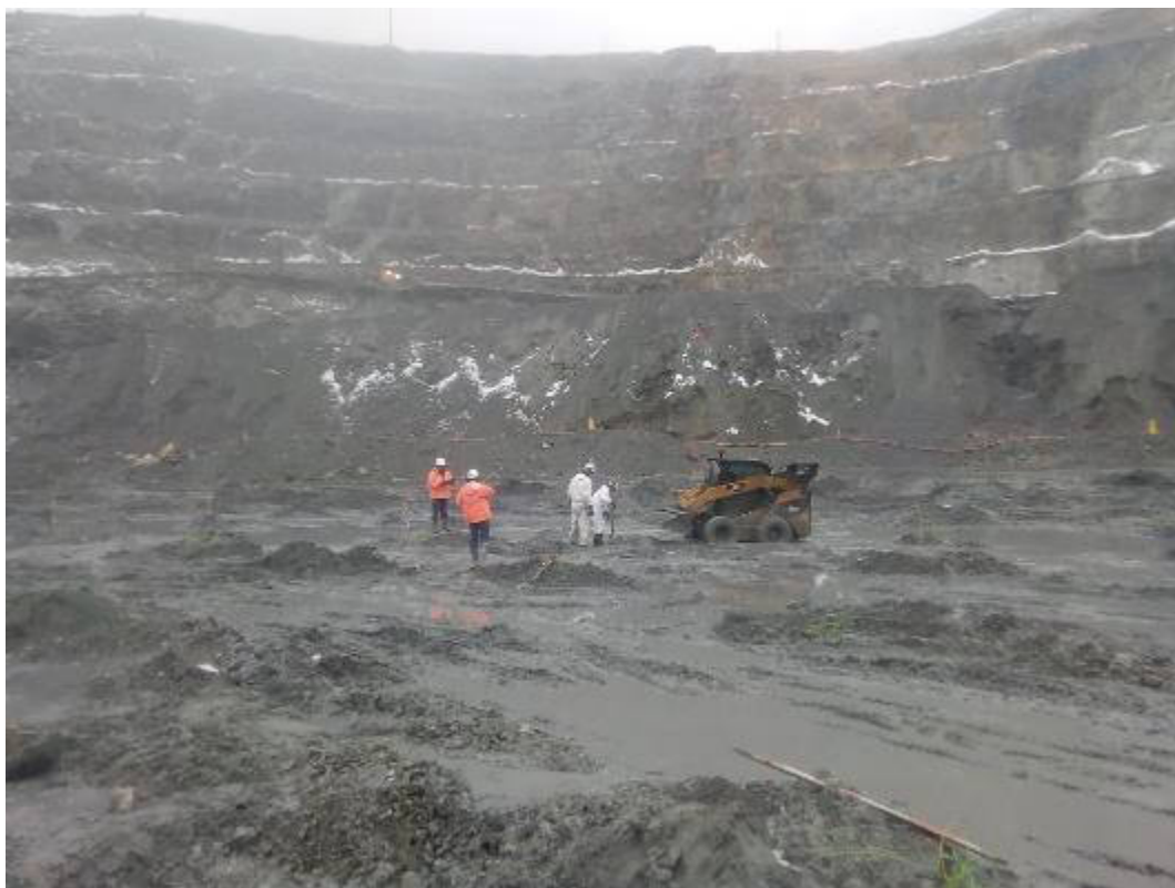
Figura 45 — Tapado de taladros utilizando mini cargador
