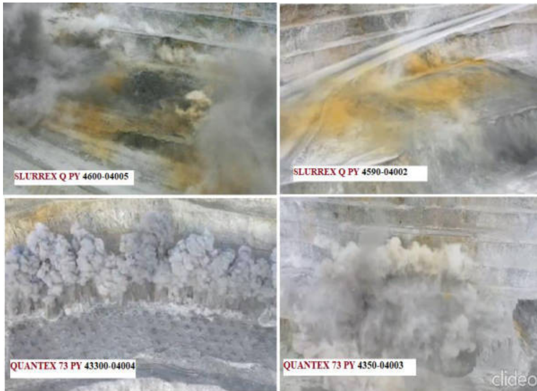
Figura 39 — Emisión de gases nitrosos Slurrex Q vs Quantex 73
