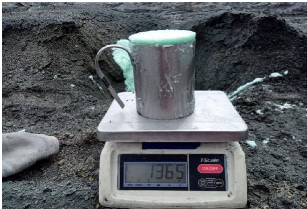
Figura 46 — Mezcla explosiva iniciando el proceso de gasificación
