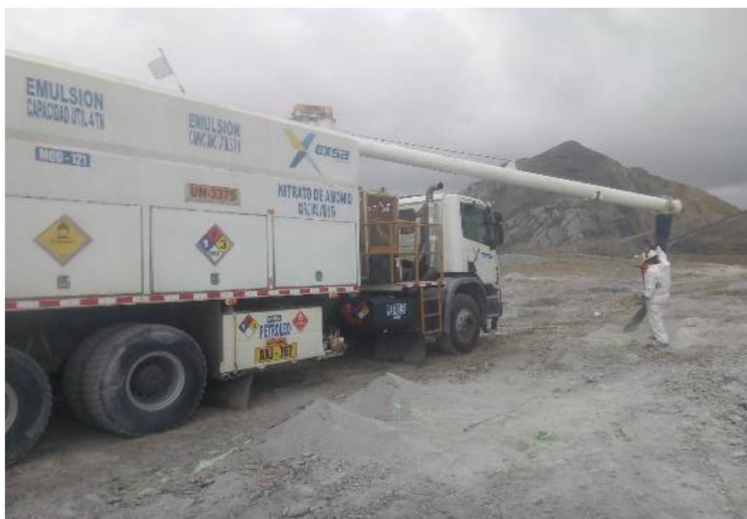
Figura 43 — Camión fábrica transportador de la mezcla explosiva Quantex 73
