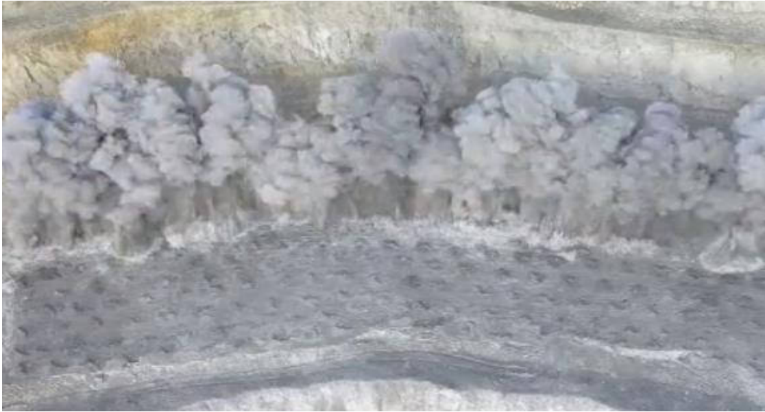
Figura 34 — Emisión de gases nitrosos Proyecto 4330-04004 Quantex 73 / valoración de acuerdo a AEISG Nivel 0
