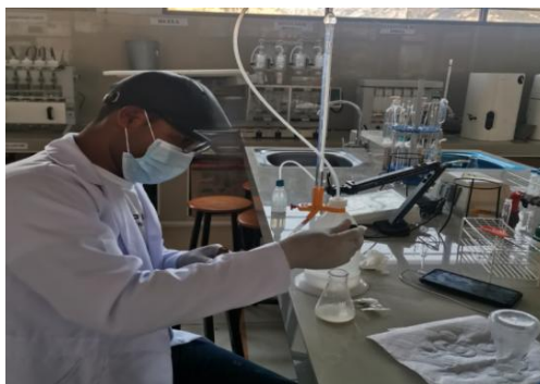
Fig. 5. Prueba de la acidez titulable, titulación con fenolftaleína 1%
