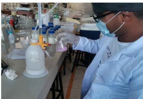
Fig. 6. Titulación con hidróxido de sodio 0.1 N
