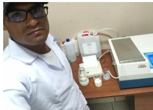
Fig. 3. Análisis químico de leche cruda con el equipo LactoStar
