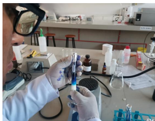
Fig. 8. Adición 1 ml de azul de metileno a muestras de leche cruda
