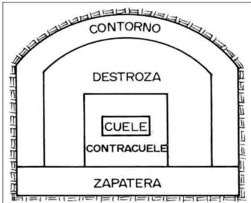
Figura N° 18 Esquema de voladura de túneles y galerías.
