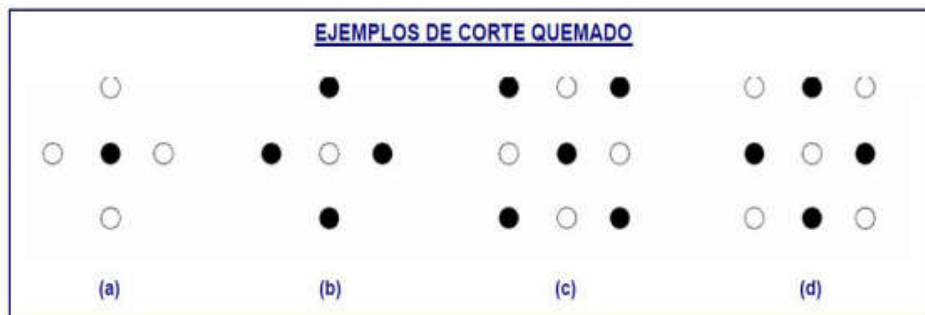
Figura N° 19 Esquema de corte quemado.
