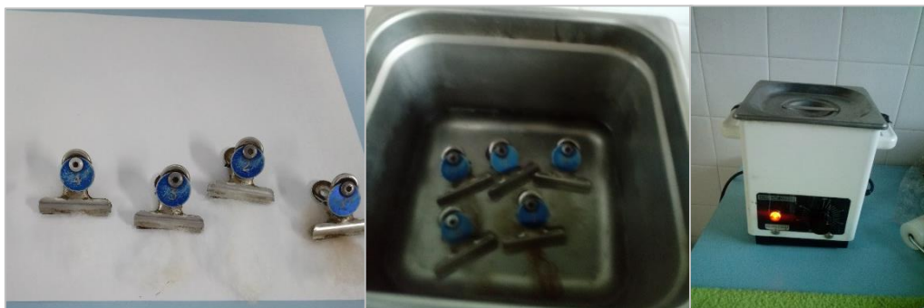
Figura 6. Preparación de muestras de mecha sucias para el lavado en solución de 20% de alcohol isopropílico y 80% de hexano.
