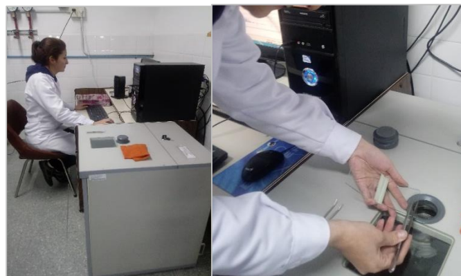
Figura 9. Análisis de muestras de fibra en el Laserscan para la comparación con el OFDA 2000 y MiniFiber EC
