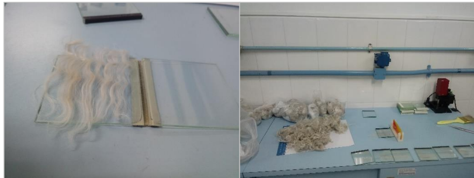
Figura 5. Preparación de muestras de mechas de fibra de origen animal en slides
