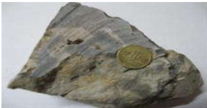
Fotografía 9. Muestra de mano con Sílice Masiva y Sílice Gris en venillas
