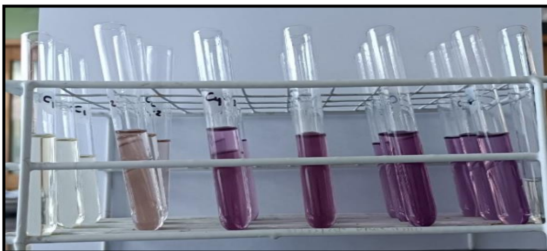
Figura 33 — Colorimetría de la curva de calibración de antioxidantes mediante el método DPPH
