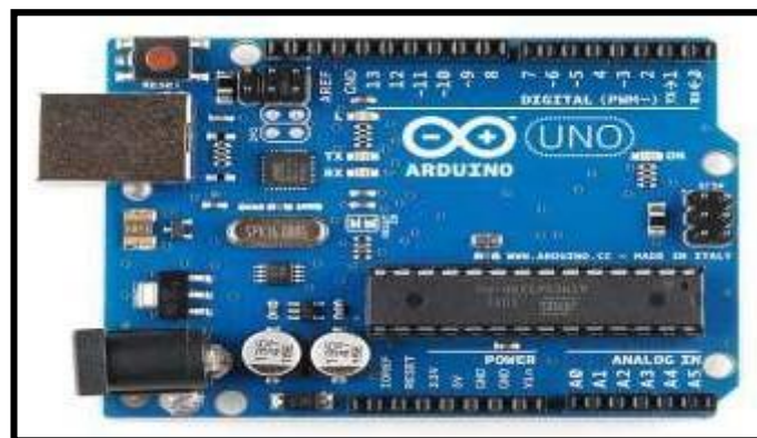
Figura 2 — Placa de Arduino Uno
