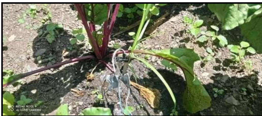
Figura 29 — Sensor de humedad instalado en la raíz de una remolacha
