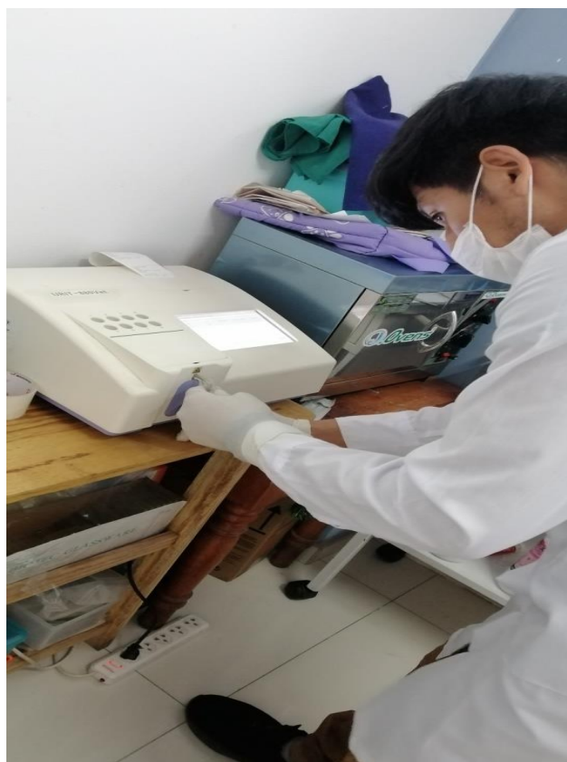
Figura 13: Lectura de muestras de crías de vicuña (Se observa el uso del equipo URIT-880 Vet, para obtener los resultados de la lectura de las muestras de las crías de vicuña).
