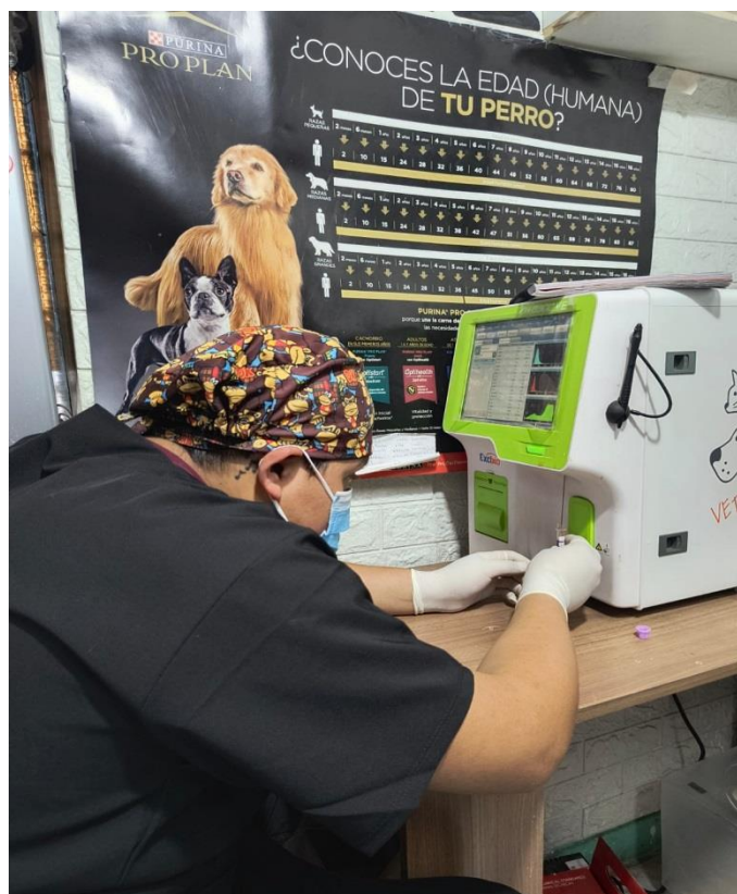
Figura 9. Introducción de la aguja del analizador hematológico en la muestra sanguínea
