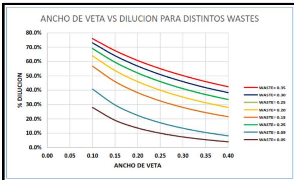
Figura 31 — % dilución vs ancho de veta para distintos valores de WASTES
