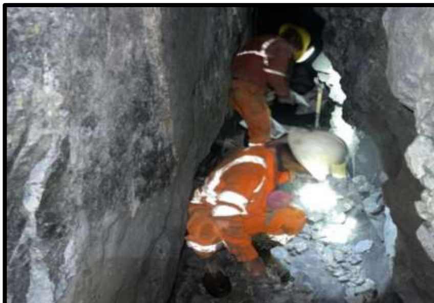
FUENTE: Compañía Minera Sol de los Andes, 2024 Figura 46 — Mineral fragmentado sobre el piso del tajeo
