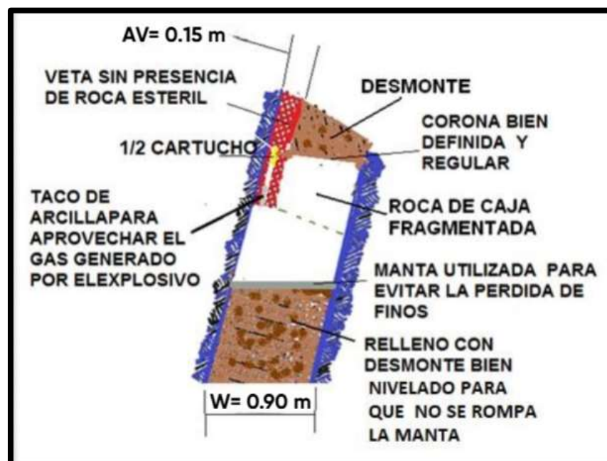
Figura 47 — Diseño del proceso después de la aplicación del método de circado
