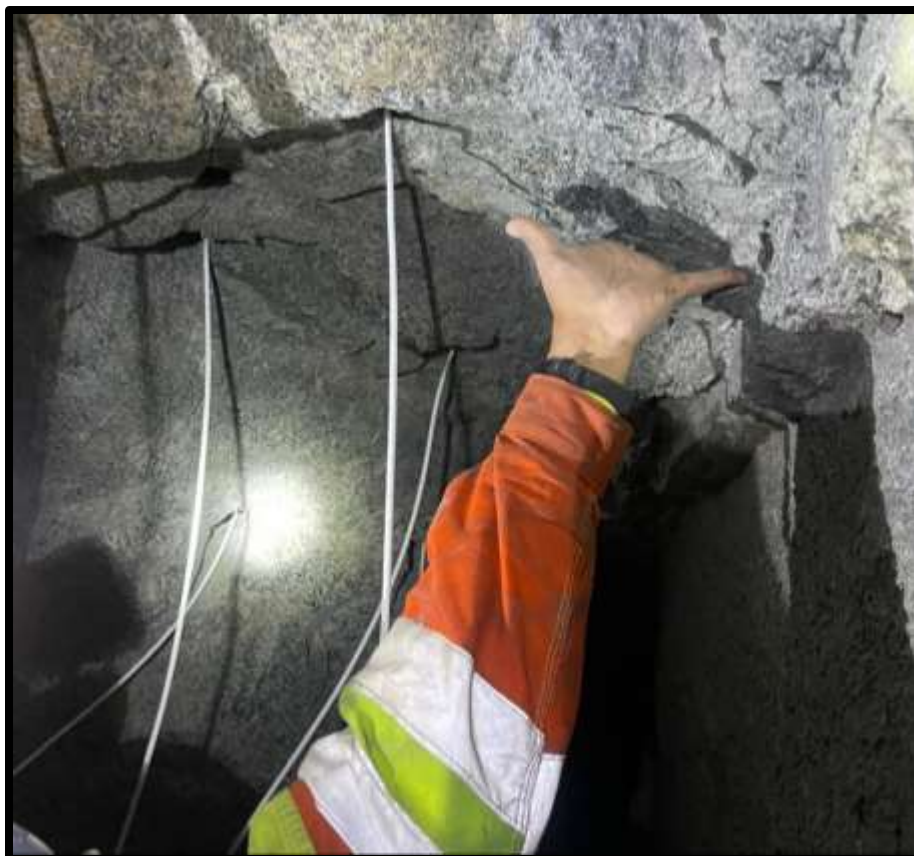
Figura 50 — Señalando el ancho de la veta
