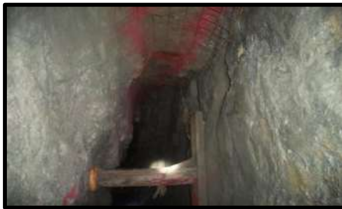
Figura 34 — Explotación de vetas angostas
