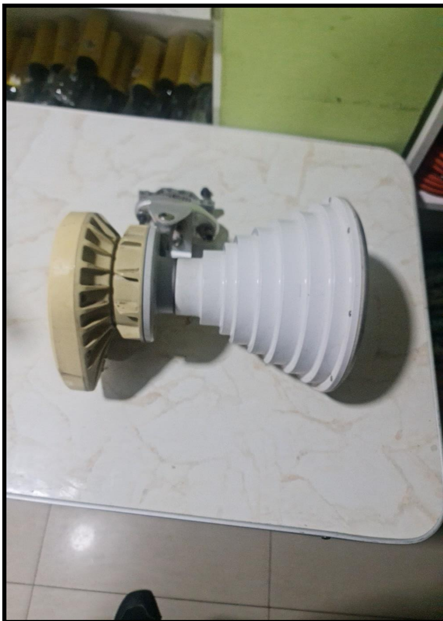
Figura 32 — Access point Mikrotik y antena RF Elements
