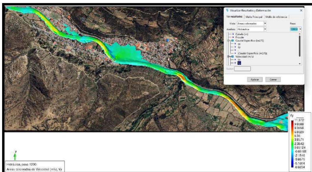
Figura 57 — Velocidad del flujo en dirección X ( V_x ) – paso 5200
