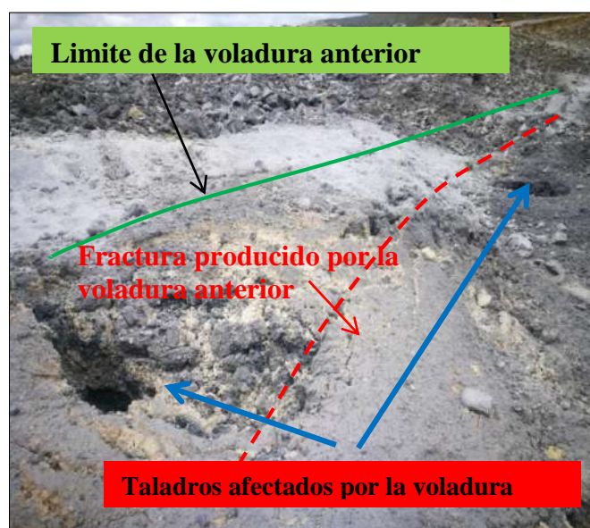
Fotografía 15: sobre quiebre en el nivel 3870 – Proyectos 005. Fuente: Asistencia técnica Orica - Las Bambas.
