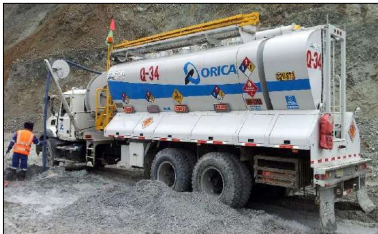
Fotografía 1: Carguío de taladros con el camión fábrica. Fuente: Propia.
