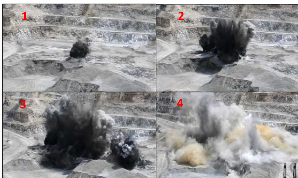
Fotografía 10: Voladura con ligera presencia de gases.
