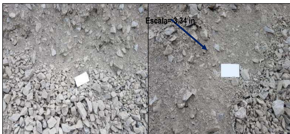
Fotografía 14: tomas fotográficas para el análisis de fragmentación del stemming. Fuente: Asistencia técnica Orica – Las Bambas.
