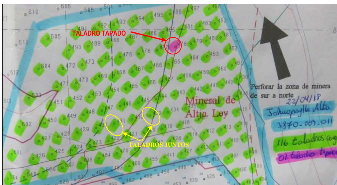
Figura 55: levantamiento del proyecto 3870 – 09 -011. Fuente: Asistencia técnica Orica – Las Bambas.
