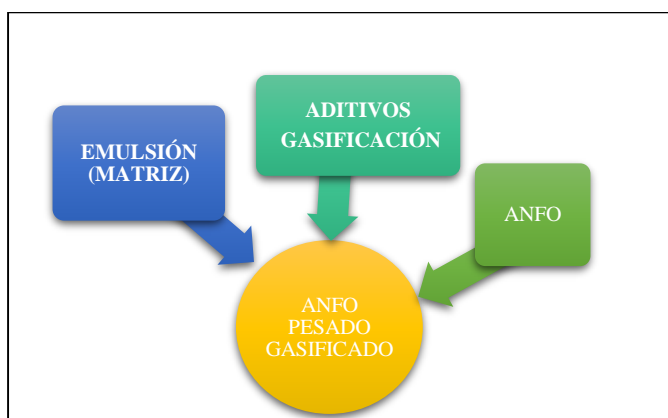
Figura 17: Componentes del Anfo pesado gasificado. Fuente: Elaboración Propia.
