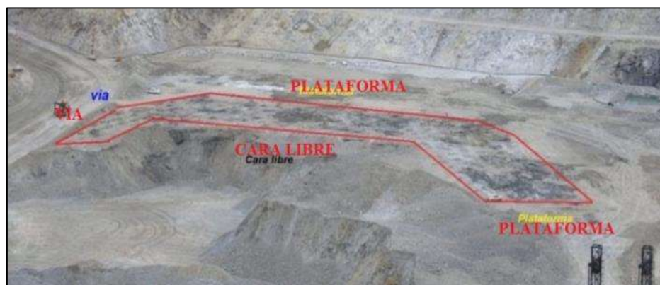
Fotografía 9: Malla de voladura del proyecto 3885-27,28,29. Fuente: Propia.
