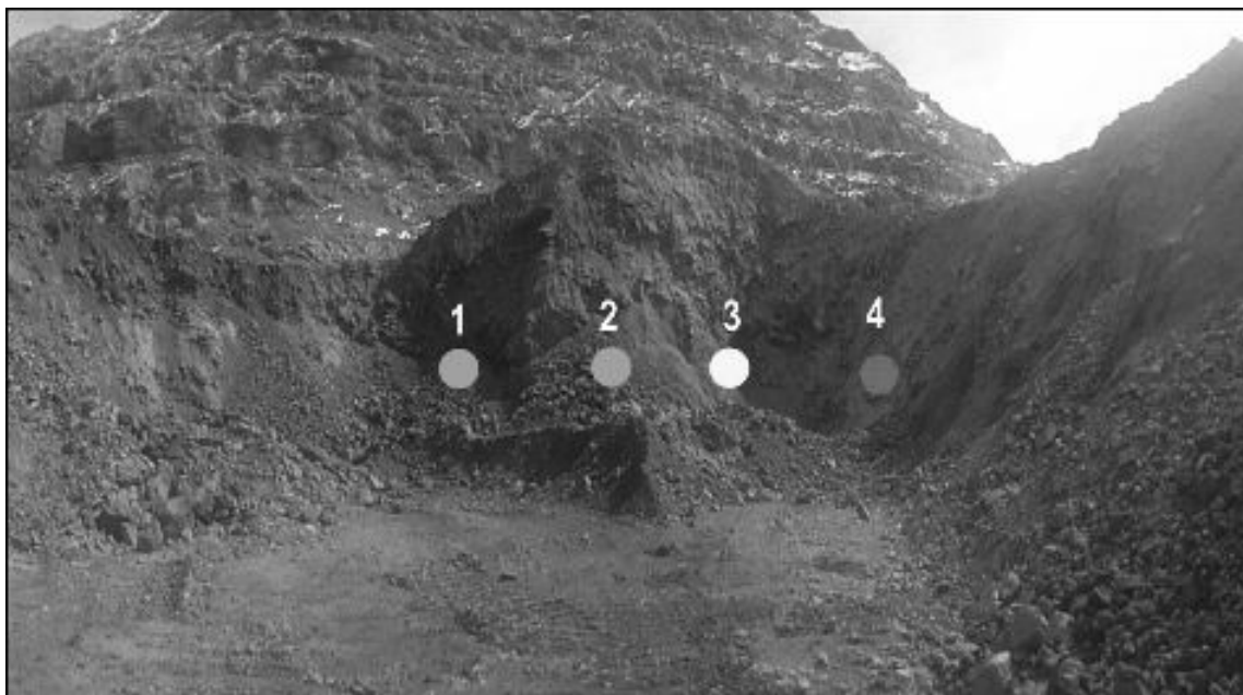
Fotografía N° 6 Zonificación del material volado mineral desmonte. Fuente: Elaboración propia.
