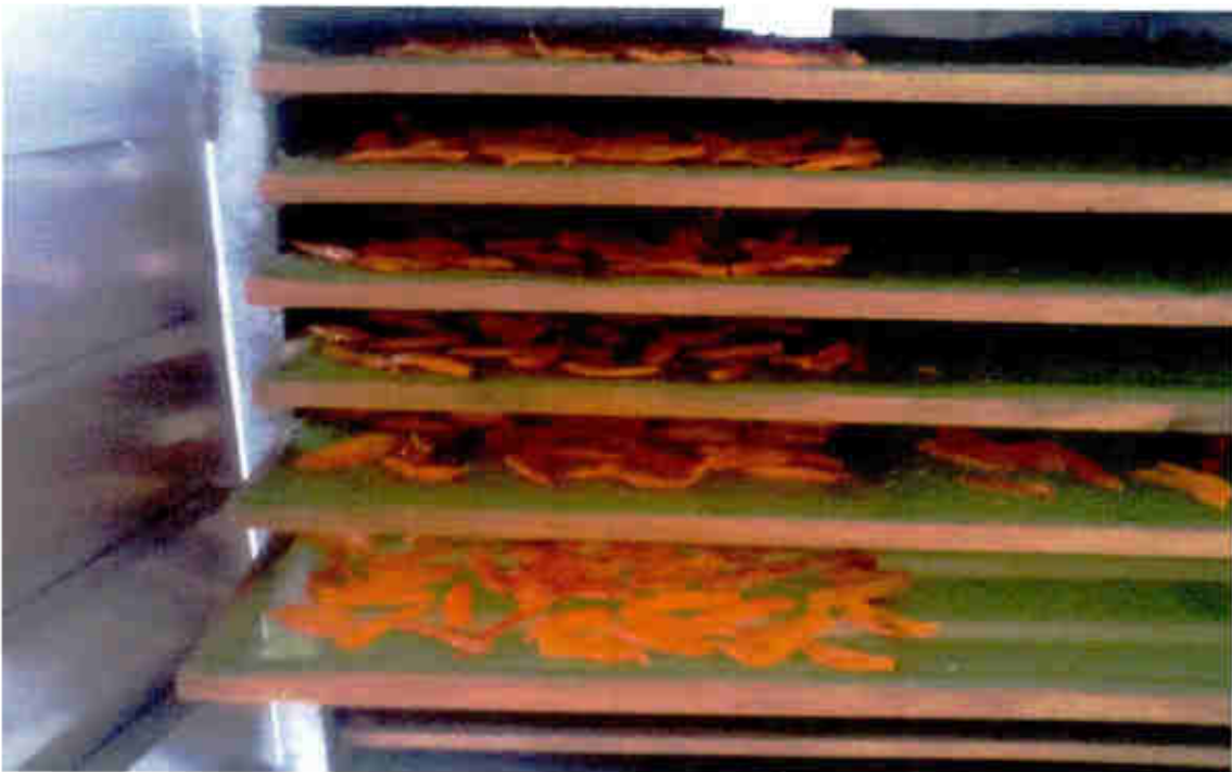
Foto 2. Secado de la páprika en el equipo secador de bandeja
