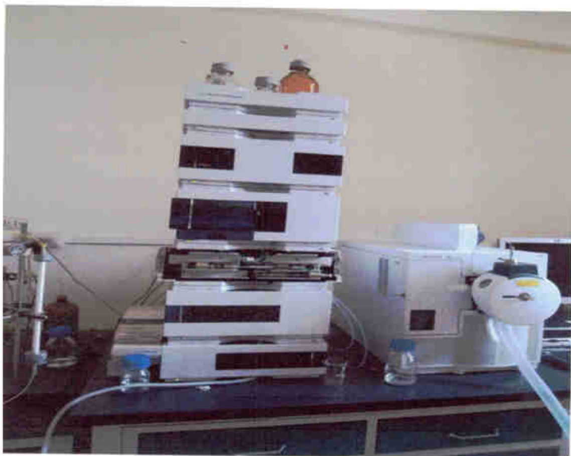
Foto 9. Equipo HPLC, utilizado para la cuantificación de la capsaicina
