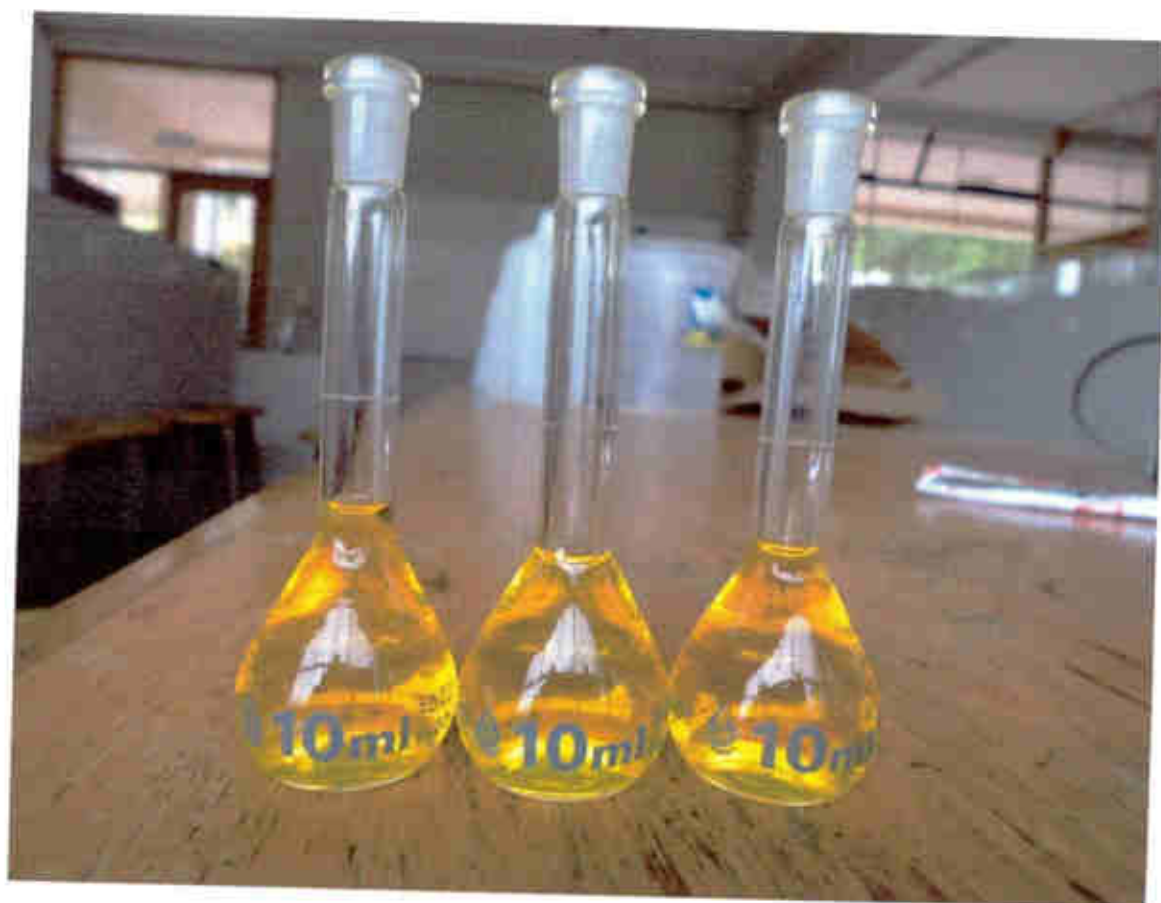
Foto 10. Muestra aforada para la determinación del color ASTA
