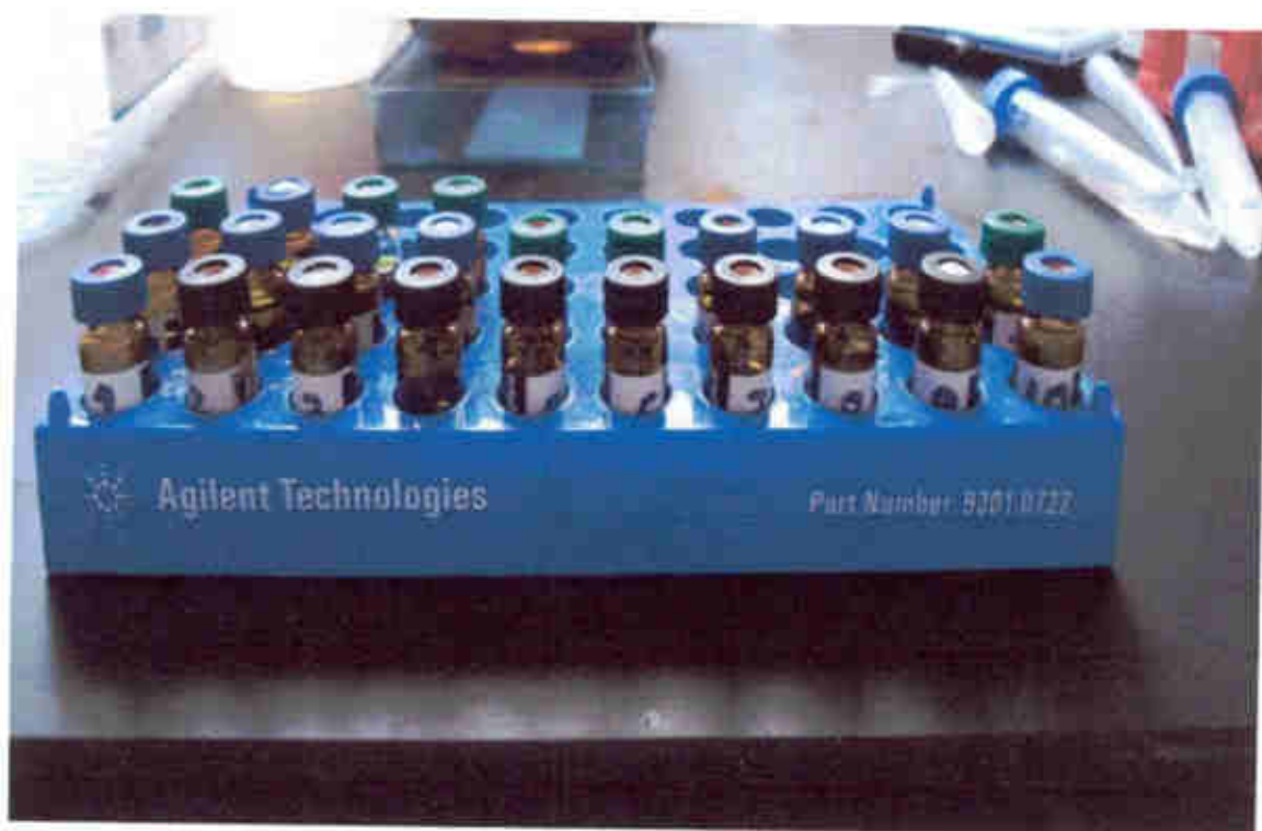
Foto 8. Muestra antes de someter al HPLC, para la cuantificación de capsaicina
