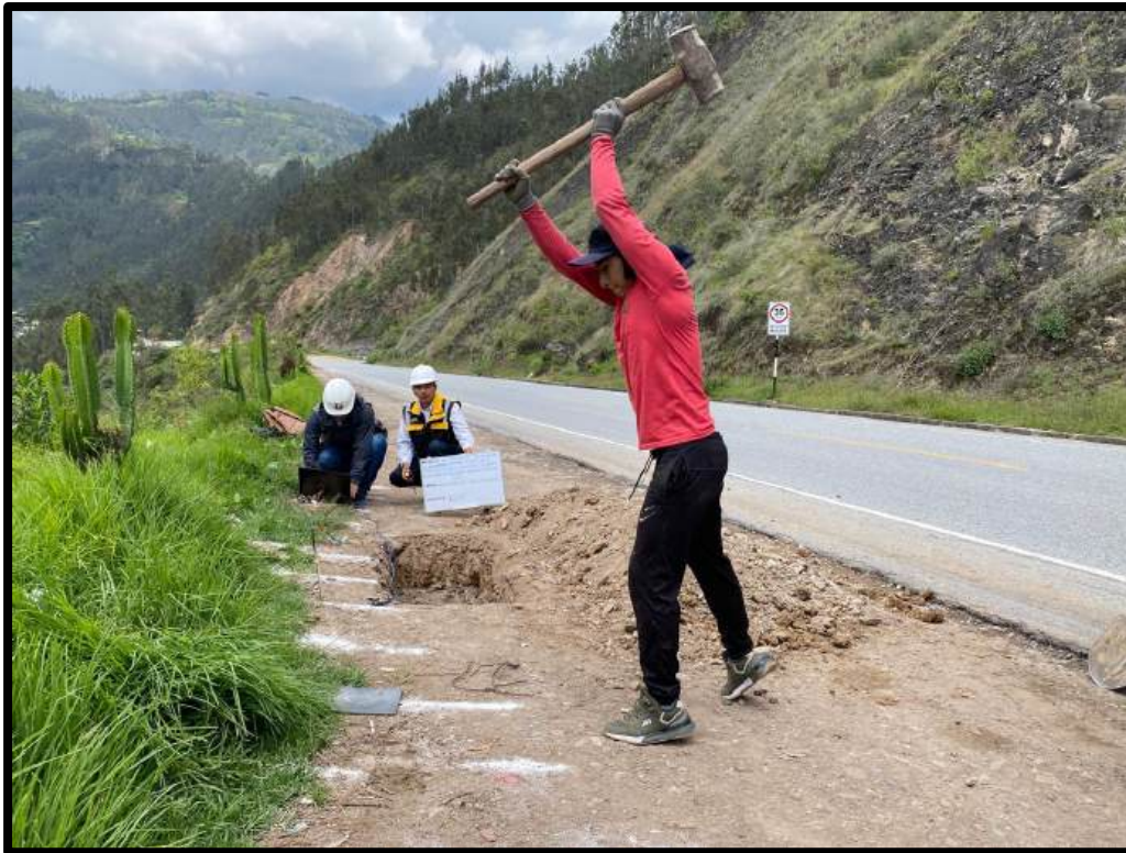
Figura 90 — Registro de aceleraciones aplicando carga
